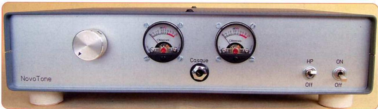
Cet amplificateur « tout triodes » développe une puissance nominale de 2 x 3 W sous 8  $\Omega$ . Sa bande passante s'étend de 30 Hz à 20 kHz à -1 dB, avec un taux de distorsion inférieur à 1 %. Les sorties haut-parleurs peuvent être commutées pour une parfaite écoute au casque. Sa consommation de l'ordre de 40 VA se révèle économique à l'usage.
