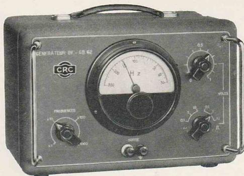
Le Générateur Basse Fréquence GB 62 est un générateur simplifié destiné à être substitué aux générateurs de laboratoire réservés pour les mesures de précision. Sa gamme de fréquence très étendue lui assure cependant un vaste champ d'application. On peut ainsi, dans certains cas, le choisir en raison de son poids et de son encombrement très réduits, ou bien de son prix relativement peu élevé.
