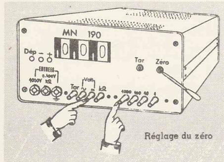
Appuyer sur la touche "Volt =" du contacteur S101 et sur la touche 1 000 du contacteur S102, agir avec un tournevis sur le potentiomètre "zéro" (R408) de manière à afficher zéro sur chacun des indicateurs numériques DS 105 - DS 107 - DS 109.
