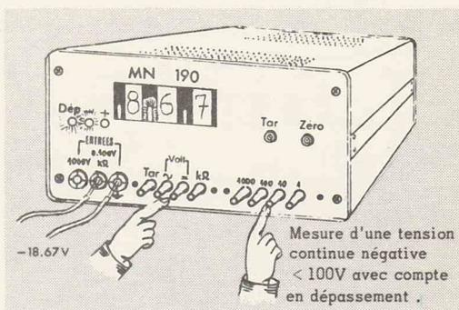
On notera que dans le cas où la mesure en dépassement est effectuée sur la position 100 du contacteur S102, enfoncer la touche 1 000 de ce contacteur et déplacer sur la borne J101 (1 000 V) la connexion d'entrée de la tension à mesurer.
