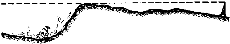
FIG. I. 5. — Obstacle gênant la vision directe : mauvaise réception.
