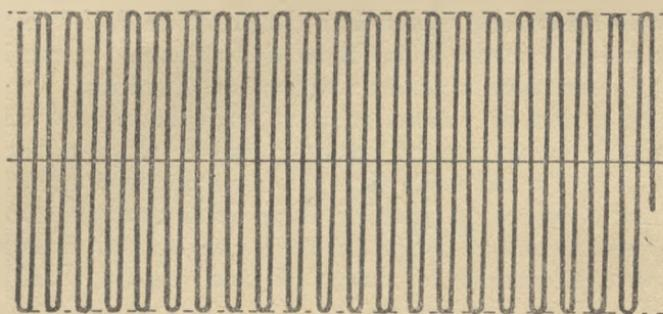
Fig. 2. — Oscillations à haute fréquence non modulées.
