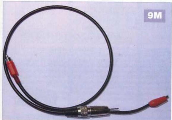
souder la pince crocodile. Il ne reste plus qu'à glisser le circuit dans le corps métallique (suivre la rainure interne) et visser le couvercle arrière, en serrant fortement pour que le contact électrique entre la masse de la plaquette et le corps soit établi. La sonde, vue de l'avant, doit ressembler à la **figure 9L** et achevée à la **figure 9M**.
