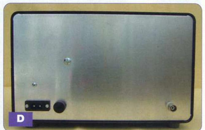
(photo C), est fixée contre la face du boîtier. Le positionnement latéral de la carte de contrôle sur les deux profilés est fixé par l'emplacement du commutateur sur la face avant. Le positionnement des deux modules et du transformateur est libre. La face arrière (photo D) supporte les socles « secteur », fusible, BNC VHF, le transformateur et le relais à trois cosses pour son raccordement.
