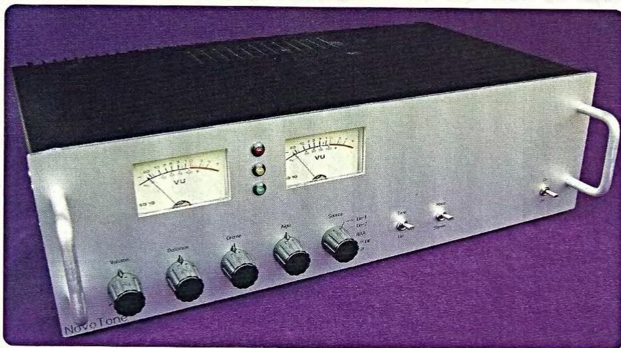
Rappelons que cette réalisation met en œuvre un circuit intégré monolithique TDA7293 dont l'étage de sortie est constitué de transistors à effet de champs. L'amplificateur développe une puissance de 2 x 60 W RMS, tout en affichant un taux de distorsion très faible, inférieur à 0,03 %. Il soutient sans faiblir une puissance continue de 2 x 100 W.
