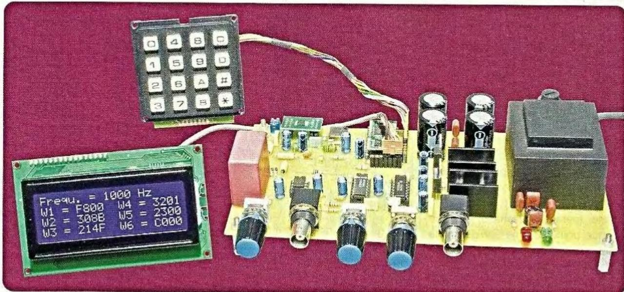
La réalisation d'un générateur de fonctions, surtout si on souhaite obtenir des fréquences élevées de plusieurs mégahertz, n'est pas chose aisée lorsque l'on utilise des composants discrets. Il existe heureusement les circuits intégrés DDS (Direct Digital Synthesis) qui, malgré leur programmation quelque peu complexe, permettent d'obtenir un signal pouvant varier de quelques millihertz à plusieurs centaines de mégahertz.
