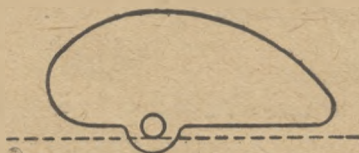
Fig. 21. — Forme de l'armature d'un condensateur à variation linéaire de longueur d'onde.
