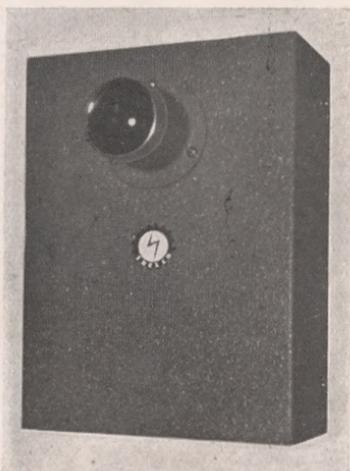
Protection de grandes surfaces avec réflexion du rayon sur 2 glaces parallèles; le coffret contient cellule, double amplificateur et relais. Cet équipement est aussi livré en coffrets étanches. Le projecteur est séparé, présenté dans un cylindre. (Cliché *Industrial Electric Equipment*, 33, rue Boussingault, Paris.)
