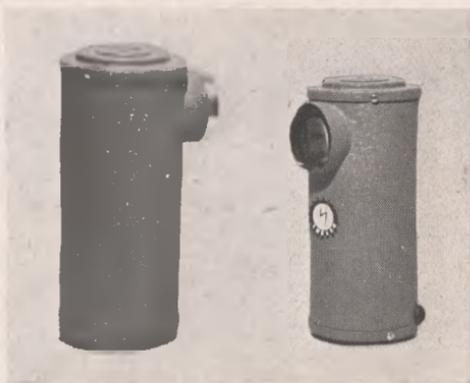
Cellule photo-électrique, amplificateur et relais contenus dans un tube de 7,7 cm de diamètre et 22,5 cm de hauteur. Usage: protection sur machines dangereuses: massicot, presse, laminoir. Distance d'utilisation: 20 mètres. Peut servir au comptage. (Cliché *Industrial Electric Equipment*.)
