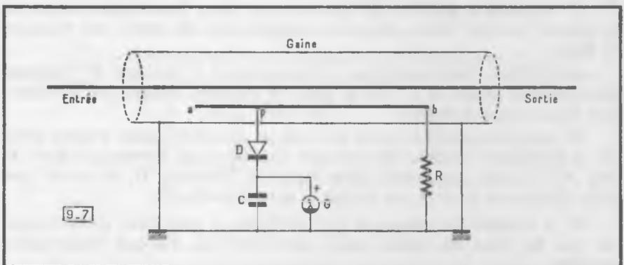
Fig. 9-7. — Principe d'un contrôleur d'ondes réfléchies à ligne.
