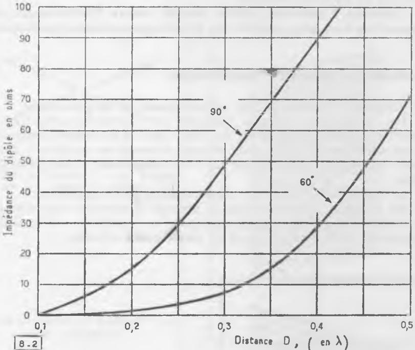
Fig. 8-2. — L'impédance du dipôle d'une antenne à réflecteur dièdre, selon la distance D de la figure 8-1.
