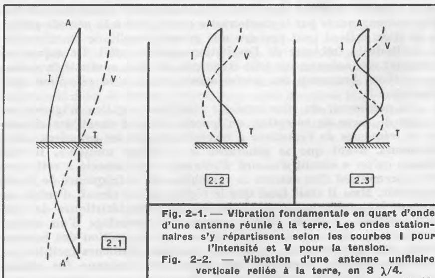
Fig. 2-1. — Vibration fondamentale en quart d'onde d'une antenne réunie à la terre. Les ondes stationnaires s'y répartissent selon les courbes I pour l'intensité et V pour la tension.
