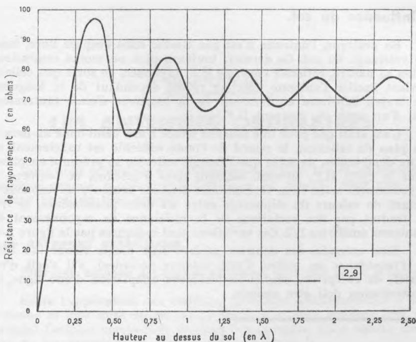
Fig. 2-0. — Variations de la résistance de rayonnement (ou impédance de l'aérien à la résonance) pour diverses hauteurs d'une antenne horizontale au-dessus du sol.
