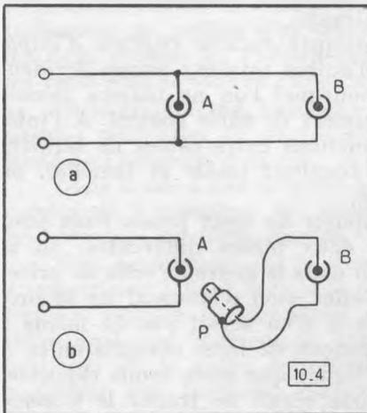
Fig. 10-4. — Lorsque le téléviseur doit être utilisé dans deux pièces, jamais il ne faut monter deux prises coaxiales comme en *a*, le tronçon *AB* se comportant alors comme une ligne résonante. C'est pourquoi l'on traitera ce tronçon comme un prolongateur (*b*).
