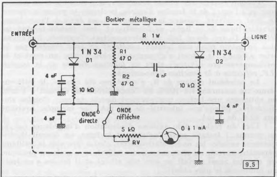
Fig. 9-5. — Un contrôleur d'ondes réfléchies.
