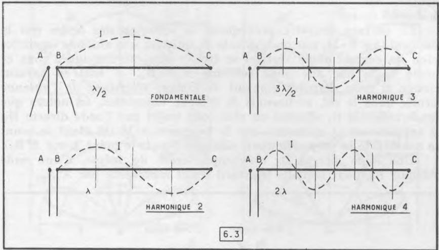
Fig. 6-3. — Une ligne accordée, connectée à l'extrémité du brin rayonnant, autorise également tous les modes de vibration sur la fondamentale et ses harmoniques.
