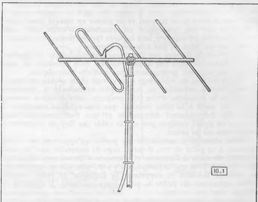
Fig. 10-1. — L'eau ne pénétrera pas dans le câble coaxial si l'on prend la précaution de le monter ainsi.
