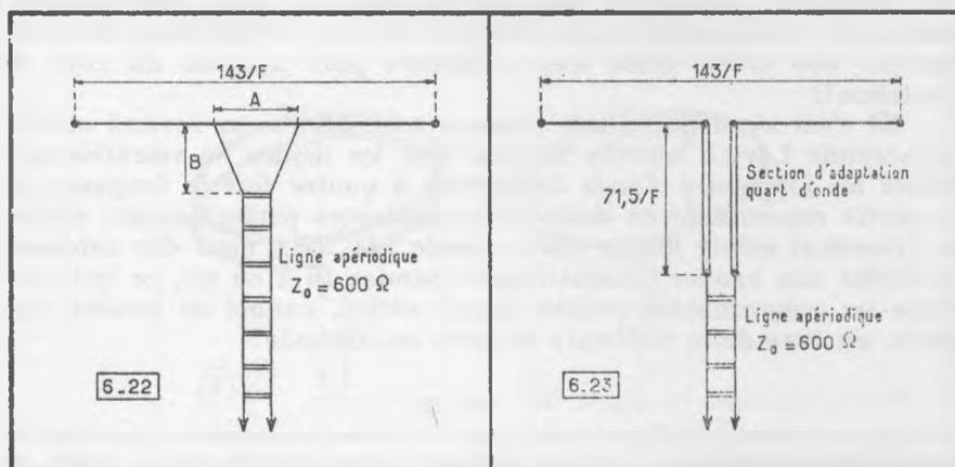
Fig. 6-22. — L'adaptation « en delta » d'une ligne d'impédance caractéristique 600 ohms à une antenne demi-onde. La fréquence  $F$  étant exprimée en mégahertz, les cotes du « delta » (en mètres) sont données par :  $A = 36/F$  jusqu'à 28 MHz ou  $34,5/F$  pour 28 MHz et au-delà ;  $B = 45/F$ .
