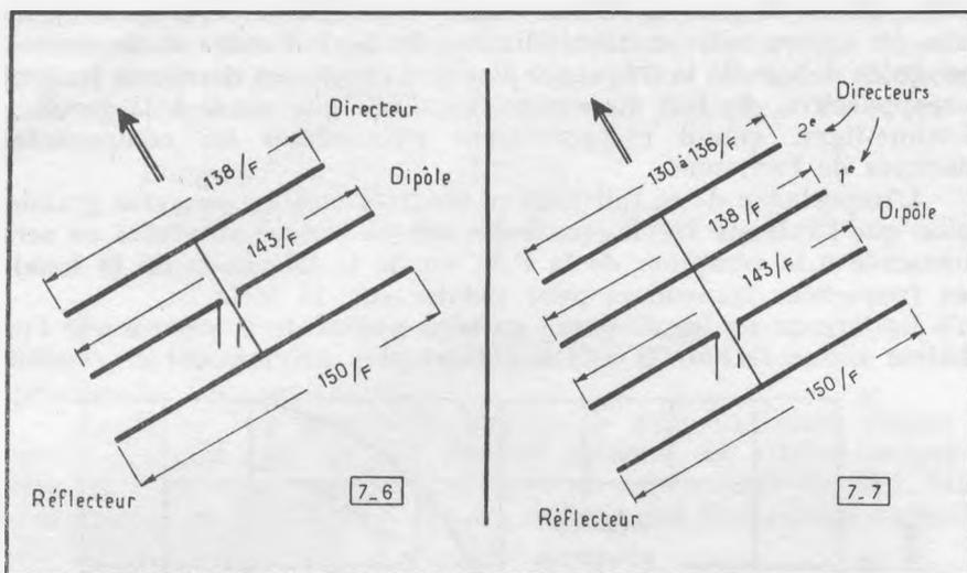
Fig. 7-6. — L'antenne directive à trois éléments.
