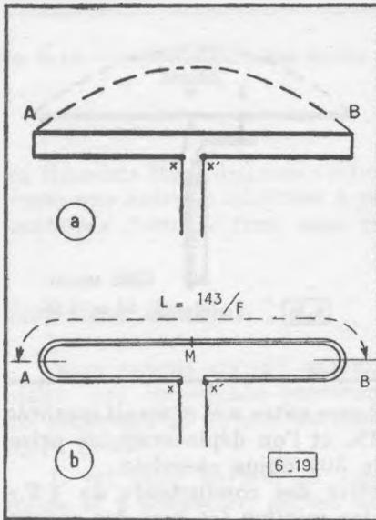
Fig. 6-19. — L'antenne « repliée » (ou folded) (a), et sa version en tube : le trombone (b).
