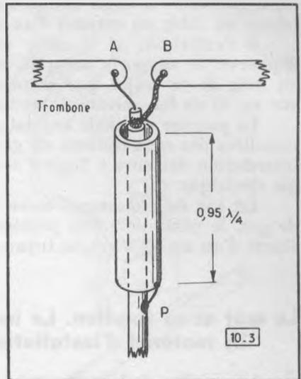
Fig. 10-3. — Réalisation d'un symétriseur « bazooka ».
