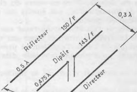
Fig. 7-8. — Abaque pour l'établissement d'une antenne à trois éléments où la distance entre le réflecteur et le directeur est fixée à  $0,3 \lambda$ . Pour les divers espacements possibles : réflecteur-dipôle et dipôle-directeur, on trouvera la longueur optimum à donner à ce directeur, ainsi que l'impédance apparaissant au milieu du dipôle.
