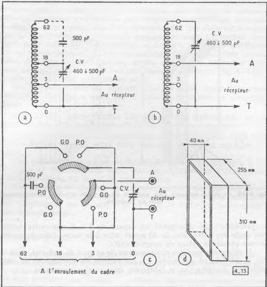
**Fig. 4-13.** — Détails d'exécution d'un cadre antiparasites simple. *a)* Les branchements en P.O. (un condensateur fixe de 500 pF accorde la partie comprise entre les spires 18 et 62 de l'enroulement, afin de décaler une absorption gênante); *b)* Les branchements en G.O.; *c)* La commutation des circuits; *d)* Les dimensions de la carcasse.
