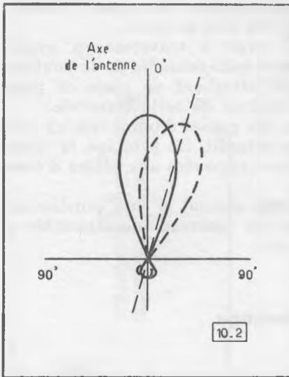
Fig. 10-2. — La dissymétrie de l'antenne a pour effet de dévier le lobe de directivité (en pointillé) d'un côté ou de l'autre de sa position normale (en trait plein) dans l'axe de l'antenne.
