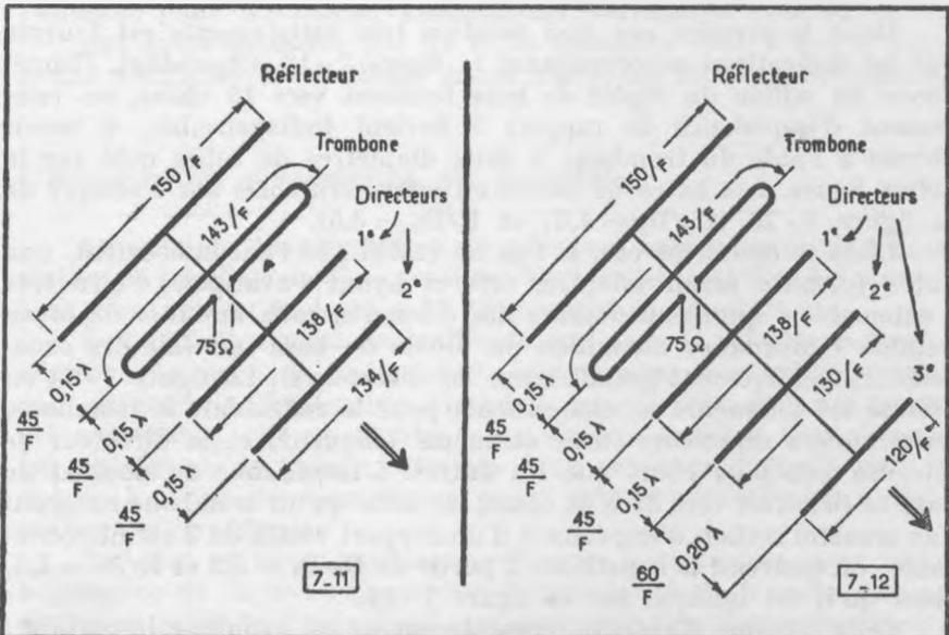
Fig. 7-11. — L'une des réalisations possibles d'une antenne à quatre éléments.
