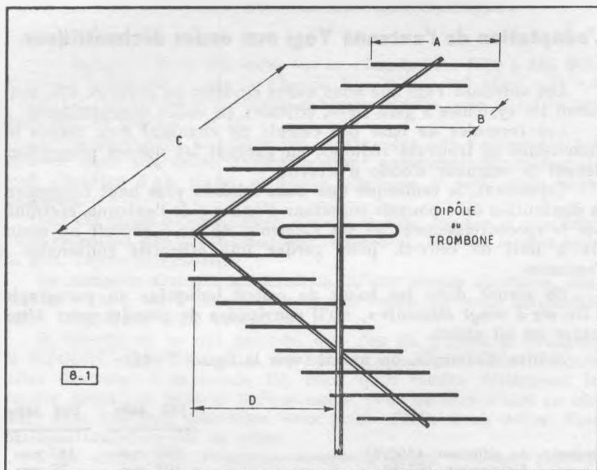
Fig. 8-1. — L'antenne à réflecteur dièdre.
