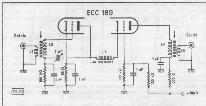
Fig. 10-10. — Schéma d'un préamplificateur d'antenne.
