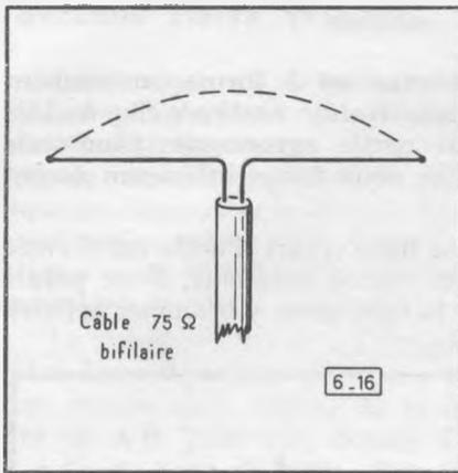
Fig. 6-16. — L'antenne doublet mono-bande.
