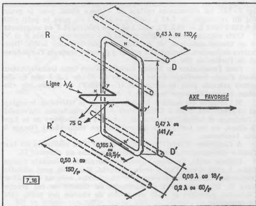
Fig. 7-16. — L'antenne « squelette ».
