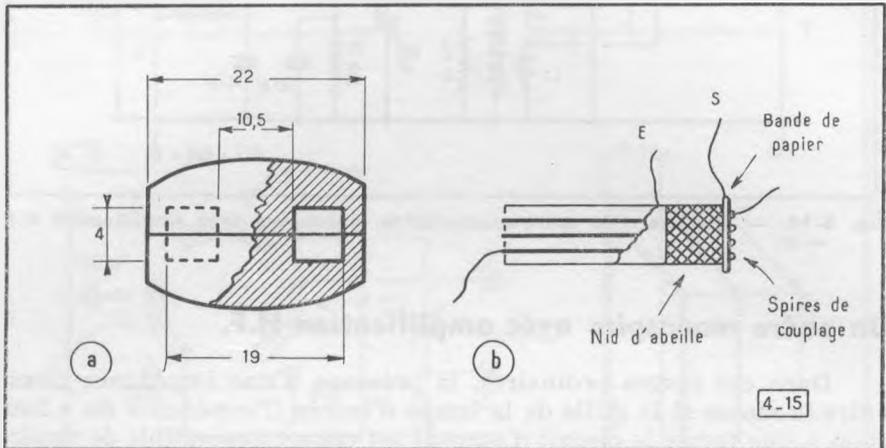
Fig. 4-15. — Cotes d'un pot magnétique (a) et exécution des bobines (b).
