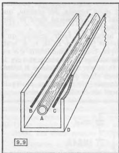
Fig. 9-9. — Détails d'exécution du tronçon de ligne, à l'intérieur du contrôleur. On voit la ligne proprement dite, en A, et les deux lignes auxiliaires, en B et C. L'ensemble est maintenu en place dans la « gouttière » D par l'intermédiaire de petits blocs en polystyrène.
