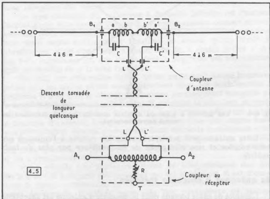
Fig. 4-5. — L'antenne antiparasites doublet « A.W.D. »
