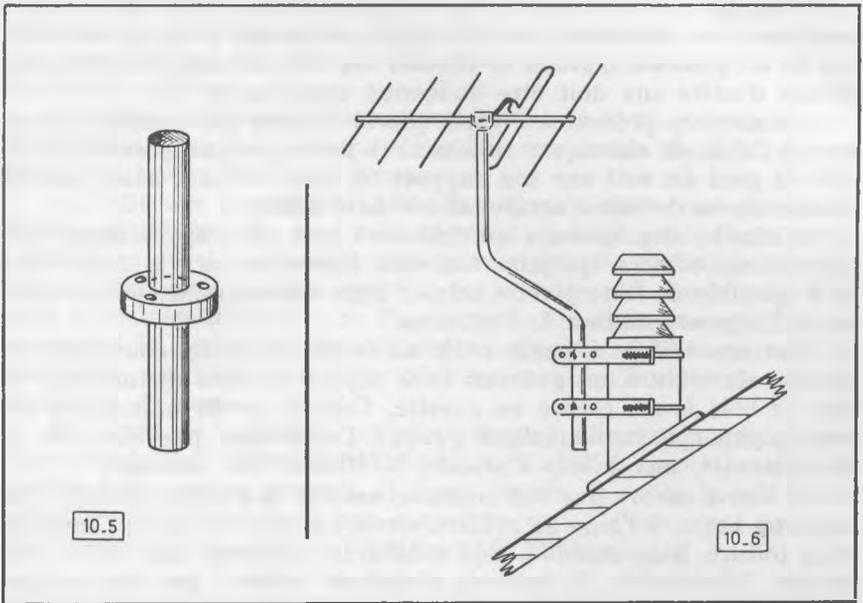
Fig. 10-5. — Un manchon pour l'assemblage des tubes d'un mât, avec sa collerette de fixation des haubans.
