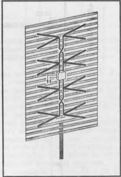
Fig. 8-5 (ci-contre). — Antenne « panneau » quadruple.
