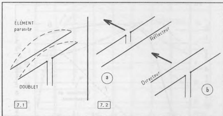
Fig 7-1. — Un élément  $\lambda/2$  placé auprès d'un doublet excité, devient le siège d'une oscillation induite et rayonne à son tour.
