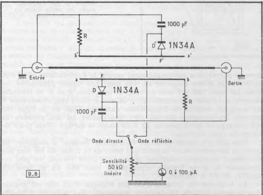
Fig. 9-8. — Schéma d'un contrôleur d'ondes réfléchies.
