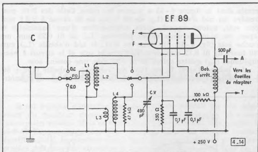
Fig. 4-14. — Schéma d'un cadre antiparasites monopaire, avec amplification H.F.
