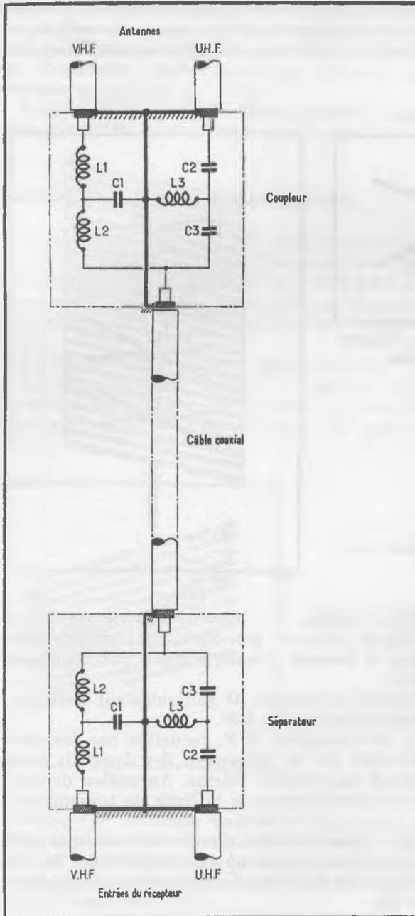
Fig. 8-6. — Un unique câble coaxial assure la liaison des antennes V.H.F. et U.H.F. au récepteur, si l'on installe un coupleur auprès des premières et un séparateur à l'entrée du second.
