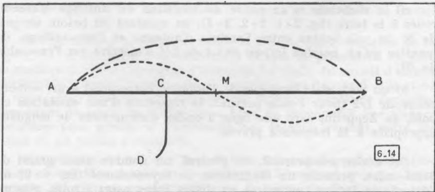
Fig. 6-14. — L'antenne Hertz-Windom.
