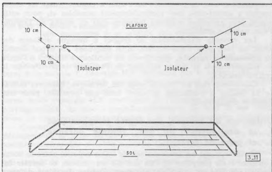
Fig. 3-11. — Un fil fin, tendu à 10 cm du mur voisin et du plafond, sera peu visible et formera une bonne antenne intérieure.
