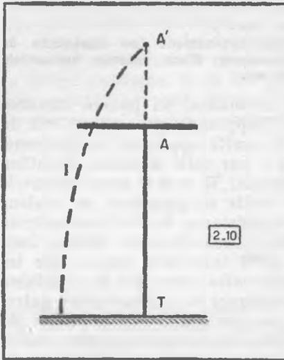
Fig. 2-10. — Lorsqu'un développement est ajouté au sommet A de l'antenne, tout se passe comme si le conducteur AT avait été allongé jusqu'en A'.
