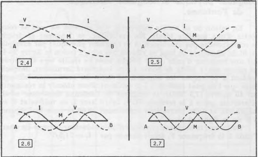
Fig. 2-4. — La vibration fondamentale d'une antenne non reliée au sol par l'une de ses extrémités, s'établit selon le régime demi-onde ( $\lambda/2$ ) avec les répartitions stationnaires de l'intensité et de la tension respectivement notées en I et V.
