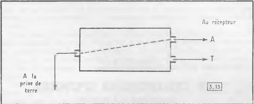
**Fig. 3-13.** — Certaines « antennes en boîte » ne comprenaient qu'une connexion réalisant la liaison entre la douille d'antenne du récepteur et la terre.
