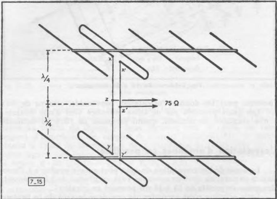
Fig. 7-15. — Comment associer deux antennes Yagi, en parallèle.
