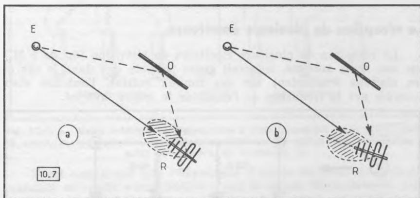
Fig. 10-7. — Dans le cas d'une réflexion d'ondes sur un obstacle O, il peut se produire une « image fantôme ». On en supprimerait la gêne en recherchant une nouvelle orientation de l'antenne.
