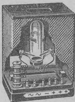
Fig. 65. — Chargeur d'accumulateurs avec ampoule rectificatrice à vapeur de mercure.
