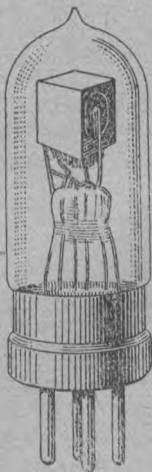
Fig. 79. — I, triode Junot; A, plaque; B, grille; C, filaments. II, lampe américaine de la Western Electric C°. III, lampe « Radiotron » à plaque de section elliptique. IV, lampe anglaise à plaque de section rectangulaire.
