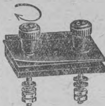
Fig. 39. - Petit condensateur variable de grille. La rotation du bouton molleté dans le sens de la flèche permet de faire varier la capacité de 0,5/10.000 à 2/10.000 de microfarad. (Modèle Bonnefont).
