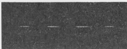
**Fig. 11-23, 11-24, 11-25.** — Aspect du faisceau lumineux modulé en intensité respectivement par un marqueur de  $1 \mu\text{s}$ ,  $0,1 \mu\text{s}$  et  $0,05 \mu\text{s}$  (de haut en bas).
