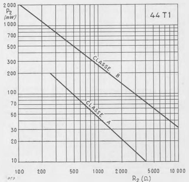
44 T 1 : Maximum de puissance de sortie  $P_2$  à 5 % de distorsion, en fonction de la résistance de charge (collecteur à collecteur dans le cas de la classe B), pour une tension d'alimentation de 12 V.
