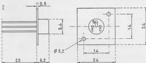
44 T 1 : Disposition des électrodes et encombrement.
