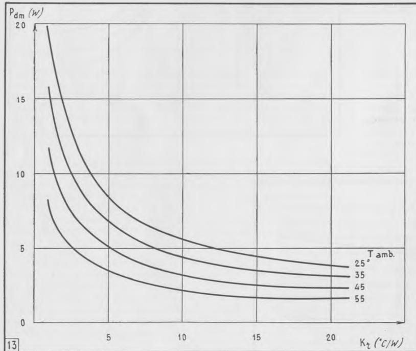
Fig. 13. — Même transistor que précédemment, puissance dissipée en fonction de la résistance thermique du radiateur, pour diverses températures ambiantes. On a tenu compte ici de la résistance thermique entre le boîtier et l'air ambiant, qui est de 30° C/W, et qui apparaît en parallèle à la somme des résistances thermiques jonction-boîtier (1° C/W) et boîtier-radiateur (0,1° C/W) due à l'isolement par rondelle de mica.
