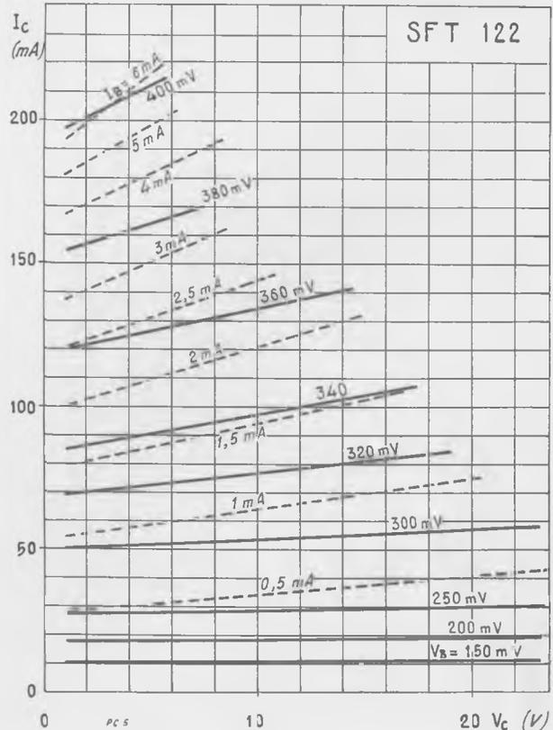
SFT 122 : Courant de collecteur IC en fonction de la tension de collecteur VC, avec tension et courant de base comme paramètres.
