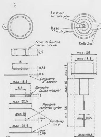
OC 16 : Disposition des électrodes et encombrement.
