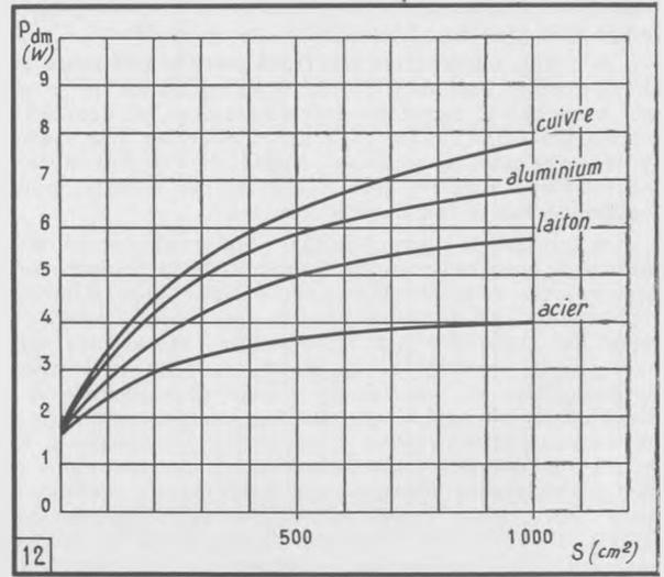
Fig. 12. — Même transistor dans les mêmes conditions que précédemment, mais fixation directe sur le radiateur.
