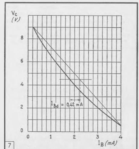
Fig. 7. — Caractéristique dynamique en commande par courant, classe B.
