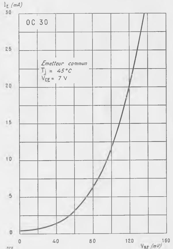
OC 30 : Courant d'émetteur  $I_E$  en fonction de la tension de base  $V_{BE}$ , dans le domaine des courants faibles.
