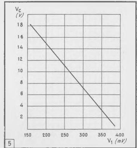
Fig. 5. — En choisissant convenablement la résistance d'attaque, on obtient une caractéristique dynamique pratiquement linéaire.
