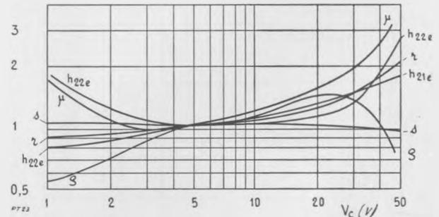
2 N 43, 2 N 44 : Ci-dessous, rapport dans lequel varient les paramètres universels et hybrides en fonction de la tension de collecteur  $V_c$ , pour  $I_c = 1 \text{ mA}$ .
