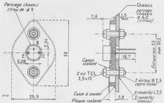
82 T 1 : Disposition des électrodes et encombrement.
