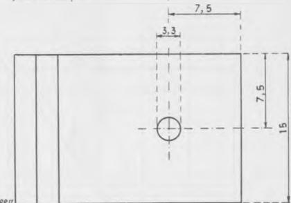
OC 76, OC 77 : Disposition des électrodes et encombrement.
