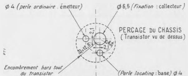
Types THP : Ci-dessus, disposition des électrodes et encombrement. Le collecteur est relié au boîtier.
