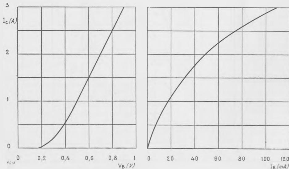
Ci-contre, courant de collecteur  $I_C$  en fonction de la tension de base  $V_B$  et du courant de base  $I_B$ .
