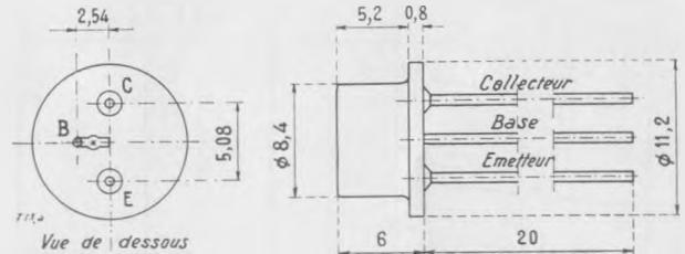
2 N 186 A, 2 N 187 A, 2 N 188 A, 2 N 241 A. Encombrement et disposition des électrodes. Boîtier métallique.
