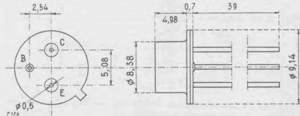
2 N 319, 2 N 320, 2 N 321 : Encombrement et disposition des électrodes. Boîtier métallique.
