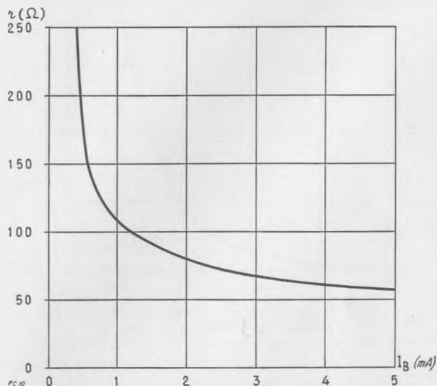
SFT 124, SFT 125, SFT 130 : Résistance d'entrée  $r$  en fonction du courant de base  $I_B$ , pour une tension collecteur-émetteur de 1 V.
