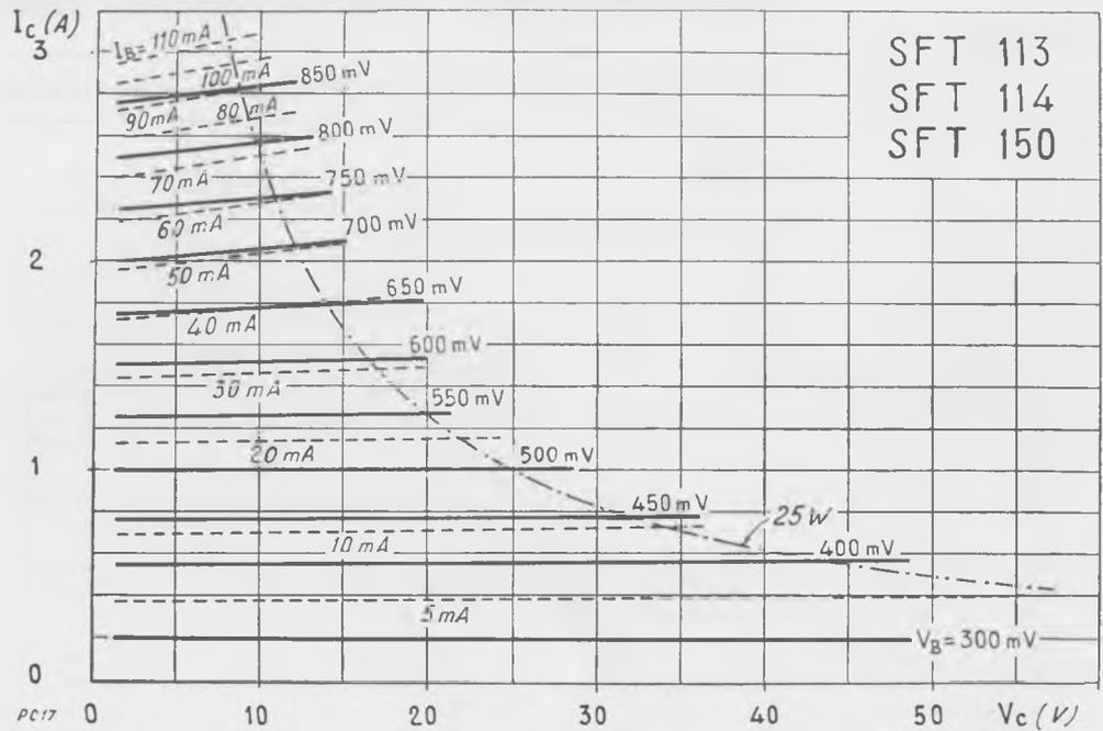
SFT 113, SFT 114, SFT 150 : Courant de collecteur  $I_c$  en fonction de la tension de collecteur  $V_c$  avec tension et courant de base comme paramètres. Pour le transistor SFT 113, la tension de collecteur ne doit pas dépasser 30 V.
