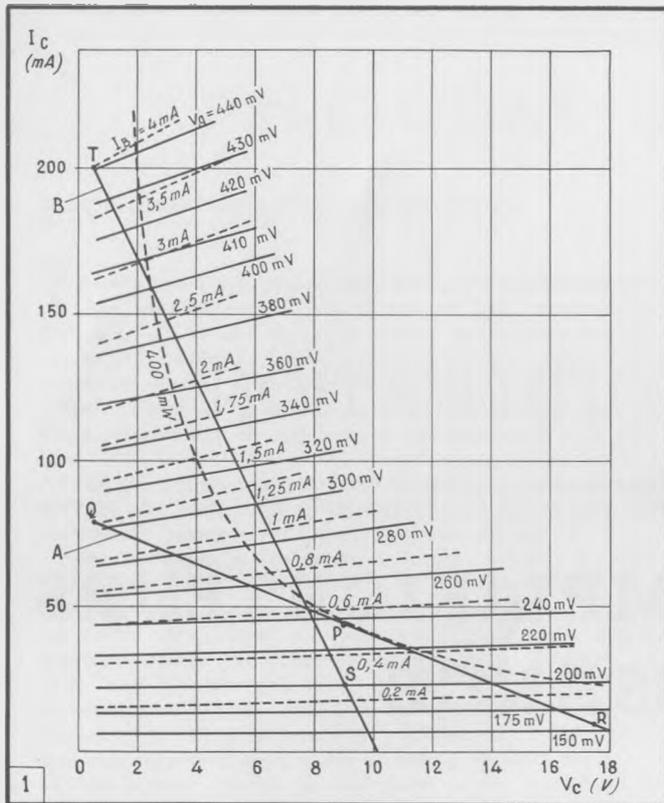
bes « courant de base ». Par analogie avec la présentation utilisée dans le domaine des tubes électroniques, les courbes « tension de base » sont ici reproduites en traits pleins, et les courbes « courant de base » en pointillés.
