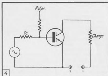
Fig. 4. — La résistance interne de la source de commande,  $R_1$ , possède une grande influence sur la linéarité d'un étage d'amplification de puissance. En traçant une droite de charge dans le réseau de courbes d'un transistor, on peut déterminer la valeur optimum de cette résistance, correspondant à un minimum de distorsion.
