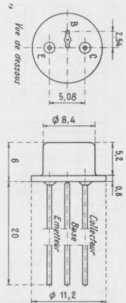
2 N 44 : Disposition des électrodes et encombrement.
