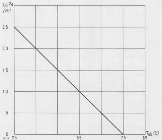
SFT 113, SFT 114, SFT 150 : Puissance dissipée maximum  $P_d$  en fonction de la température du centre de l'embase de fixation du boîtier  $T_{eb}$ .
