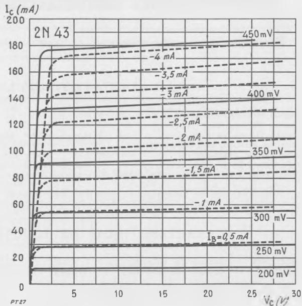
2 N 43 (en haut) et 2 N 44 (en bas) : Courant de collecteur  $I_C$  en fonction de la tension de collecteur  $V_C$ , avec tension et courant de base en paramètre; faibles intensités de collecteur à gauche, fortes intensités à droite.
