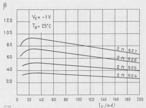
2 N 524, 2 N 525, 2 N 526, 2 N 527 : Gain en courant  $\beta$  en fonction du courant de collecteur  $I_C$ , pour une tension de collecteur de 1 V. Montage émetteur commun.
