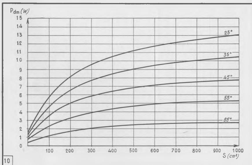
Fig. 10. — Transistor d'une résistance thermique jonction-boîtier de 1°C/W, supportant une température maxima de 75°C (OC 16), puissance dissipée en fonction de la surface d'une plaque radiatrice horizontale en aluminium brillant, pour diverses températures ambiantes.
