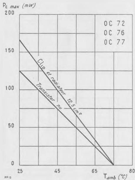
Ci-contre, puissance maximum dissipée  $P_{0 \text{ max}}$  en fonction de la température ambiante  $T_{amb}$ , pour la température maximum de jonction.
