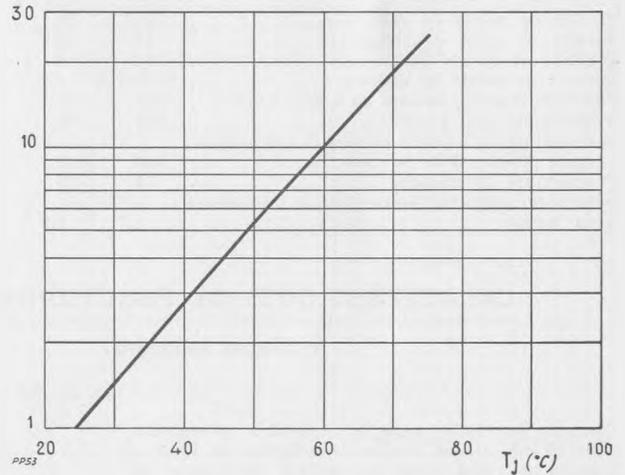
OC 74 : Ci-dessus, rapport dans lequel augmente le courant de saturation de collecteur en fonction de la température de jonction  $T_j$ .
