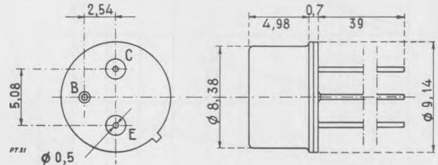
2 N 524, 2 N 525 : Disposition des électrodes et encombrement. Boîtier métallique.
