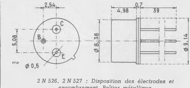
2 N 526, 2 N 527 : Disposition des électrodes et encombrement. Boîtier métallique.
