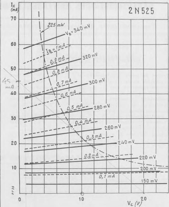
2 N 524, 2 N 525, 2 N 526, 2 N 527 : Réseaux de caractéristiques en émetteur commun représentant le courant de collecteur  $I_c$  en fonction de la tension de collecteur  $V_c$ , avec tension et courant de base comme paramètres.
