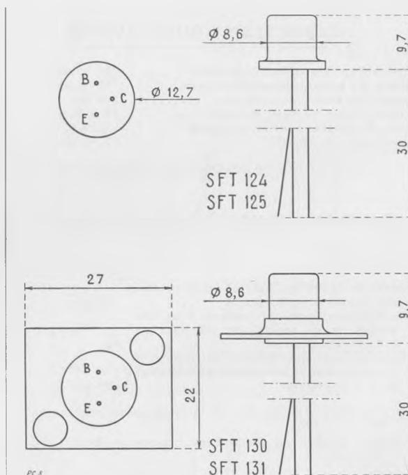
SFT 124, SFT 125, SFT 130 : Disposition des électrodes et encombrement. Le collecteur est réuni électriquement au boîtier et repéré par un point de couleur.
