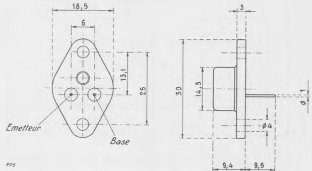
OC 30 : Disposition des électrodes et encombrement.
