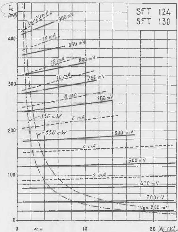
SFT 124, SFT 130 : Courant de collecteur  $I_c$  en fonction de la tension de collecteur  $V_c$ , avec tension et courant de base comme paramètres.
