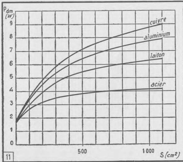
Fig. 11. — Même transistor que précédemment, puissance dissipée en fonction de la surface de radiateur, pour une température ambiante de 45°, fixation du transistor par rondelle de mica.
