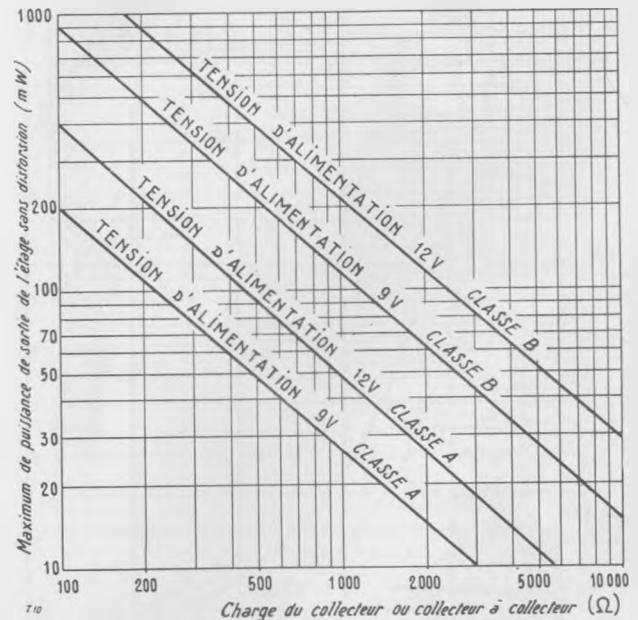
Ci-dessus, abaque permettant de déterminer l'impédance de charge en fonction de la puissance de sortie demandée. Valable pour tout transistor de moyenne puissance, à condition de respecter les limites de tension et de dissipation.
