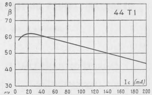
Ci-dessus, gain en courant  $\beta$  en fonction du courant de collecteur  $I_c$ , pour une tension de collecteur de 1 V.
