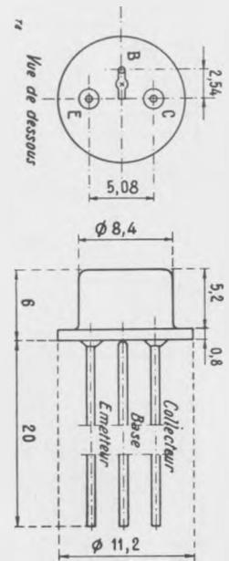
2 N 43 : Disposition des électrodes et encombrement.
