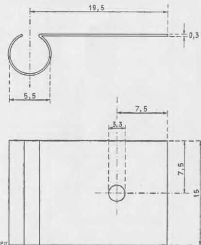
OC 72 : Disposition des électrodes et encombrement. Si, au lieu d'utiliser un support, on soude le transistor directement dans le montage, effectuer les soudures au moins à 10 mm du corps du transistor, et cela en interposant une pince froide.
