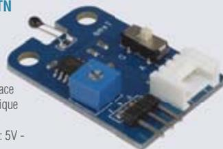
**Caractéristiques techniques :** Interface : GROVE4 et 3 broches - Sortie : Analogique ou par seuil - Réglage par potentiomètre - Capteur : CTN 10kohm - Alimentation : 5V - Dimensions : 36x24mm
