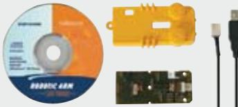
**Contenu :** 1 interface USB 2.0 avec son couvercle - 1 CD-Rom avec notice, logiciel et pilote en anglais - 1 câble USB
