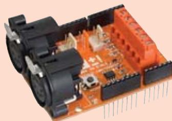
**Caractéristiques :** Master DMX : jusque 512 modules en parallèle - Fonctionnement : Entrée et sortie - Lignes DMX : GND, D+ et D- - Connexions DMX : XLR et borniers - Connexions T : 1 x 4, 1 x 3 analog et 1 x 3 digitale - Bouton : Reset - Encembrement : Shield format UNO
