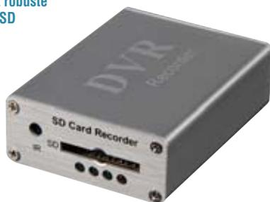
**Caractéristiques techniques :** Stockage : Carte SD (non fournie) - Entrée audio/vidéo : Jack 3.5mm - Sortie audio/vidéo : Jack 3.5mm - Fréquence : 5, 15 ou 30 images par seconde - Résolution : 230x288, 640x576 ou 704x576px - Alimentation : 5 à 30Vdc
