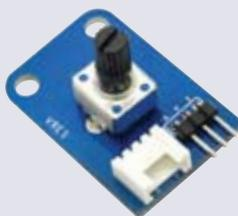
**Caractéristiques techniques :** Interface : GROVE4 et 3 broches - Sortie : 0 à V+ - Alimentation : 24V max. - Dimensions : 36x24mm
