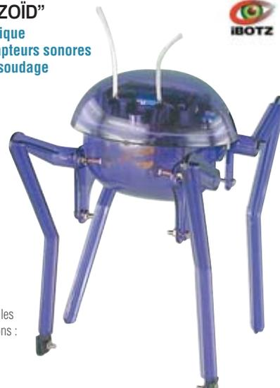
**Caractéristiques :** Module électronique pré-câblé - Propulsion par mouvement de pattes mues par un moteur continu - Alimentation par 2 piles LR6 (non fournies) - Dimensions : 195x125x155mm
