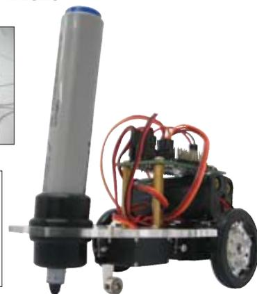
**Contenu :** 1 carte contrôleur câblée - 1 plaque acrylique de 3mm découpée au laser - 3 servomoteurs - 2 roues complètes - 1 porte marker - 1 jeux de visserie - 1 ensemble de quincaillerie
