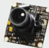
**Caractéristiques techniques :** Capteur : CCD 1/3» Sony 960H Exview HAD CCD II - Résolution : 976Hx582V - Objectif : 2.8mm - Obturateur : 1/60 à 1/100000 - Sensibilité : 0,01Lux à f1.2 - Ratio S/B : 48dB - Standard : NTSC / PAL - Tension de fonctionnement : 12V - Consommation : 70mA - Température de fonctionnement : -20 à 60°C
