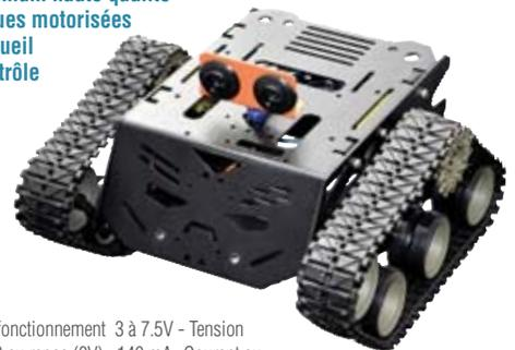
**Moteurs :** Tension de fonctionnement 3 à 7.5V - Tension nominale : 6V - Courant au repos (3V) : 140 mA - Courant au repos (6V) : 170 mA - Vitesse au repos (3V) : 90 t/min - Vitesse au repos (6V) : 160 t/min - Couple max : 0,8 kgf.cm - Courant max : 2,8 A - Ratio de réduction : 1:120 - Diam. axe de sortie : 5,4 mm
