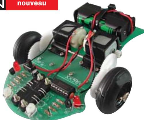
**Contenu :** 2 roues à bande caoutchouc - 1 roue folle - 2 moteurs DC - 1 support de batteries - 1 PCB - 3 photo détecteurs - LEDs d'état - LEDs de direction - Résistances - Condensateurs - Transistor - Connecteurs et broches - Câbles - Pièces mécaniques - Notice de montage
