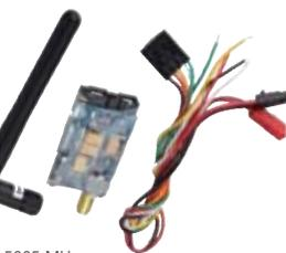
**Caractéristiques techniques :** Fréquence 1 : 5705 MHz - Fréquence 2 : 5685 MHz - Fréquence 3 : 5665 MHz - Fréquence 4 : 5645 MHz - Fréquence 5 : 5885 MHz - Fréquence 6 : 5905 MHz - Fréquence 7 : 5925 MHz - Fréquence 8 : 5945 MHz - Format Vidéo : NTSC / Pal - Impédance de sortie : 50ohm - Puissance de sortie : 21 à 23dBm - Largeur de bande : 0 à 8,0MHz - Connecteur d'antenne : SMA - Tension d'alimentation : 8 à 12V - Courant d'alimentation : 150mA - Dimensions : 55x26x17mm
