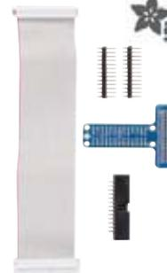
**Composition :** 1 circuit T-Cobbler - 1 nappe 26 conducteurs - 2 connecteurs 2x13 pts à sertir - 1 connecteur Mâle 2x13 pts à souder - 1 barrette HE14
