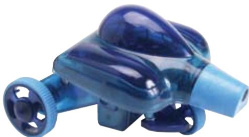
**Caractéristiques :** Distance de détection : 50cm max. - Alimentation par 2 piles LR6 (non fournies) - Dimensions : 14x12.5x9.5cm.
