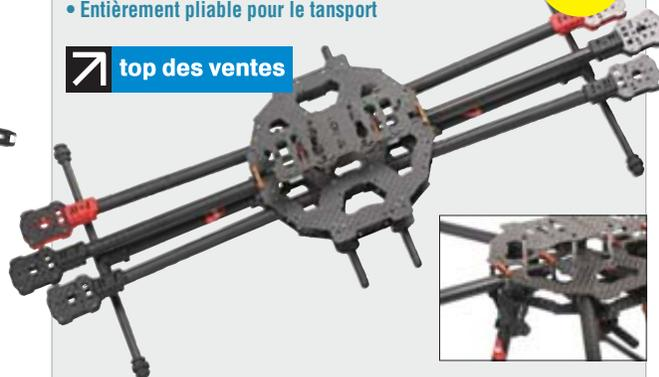
**Caractéristiques techniques :** Matériau : fibre de carbone - Train d'atterrissage : Repliable - Entre-axes : 680mm moteur à moteur - Garde au sol : 180mm - Hauteur totale : 220mm - Poids : 600g
