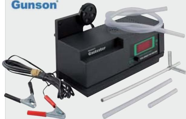
**Caractéristiques techniques :** Gamme de mesure utile de 0 à 10% de CO - Gamme de mesure indicative de 10 à 20% de CO - Alimentation en 12V sur la batterie de la voiture (pinces fournies) - Dispositif de rejet de l'eau condensée inclus - Fourni avec sonde, tuyaux, manuel - Dimensions : 240x110x150mm - Poids : 850g
