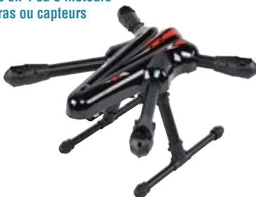
**Caractéristiques techniques :** Matériau de la structure : Aluminium - Matériau de la coque : Plastique thermoformé - Configurations possibles : 4 ou 8 moteurs (2 moteurs par bras) - Entre-axes : 450mm moteur à moteur - Poids : 670g
