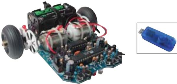
**Caractéristiques techniques :** Processeur : RISC - Moteurs : 2 moteurs DC indépendants - Interface de programmation : USB - Interface de contrôle : IR duplex - Capteurs : 6 touches de collision, 1 cellule optique, 2 odomètres - Alimentation : 3V par 2 piles LR03 / AAA - Consommation : 300mA - Dimensions : H70x1160xL90mm
