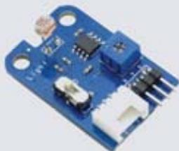
**Caractéristiques techniques :** Interface : GROVE4 et 3 Broches - Sortie : Analogique ou par seuil - Seuil de basculement réglable - Alimentation : 5V - Consommation : 5mA - Dimensions : 36x24mm
