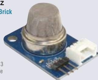
**Caractéristiques :** Interface : Grove4 et 3 broches - Plage : 200 à 10000ppm - Sortie : analogique 0 à 5V - Alimentation : 5V - Consommation : 122mA - Dimensions : 33x14mm
