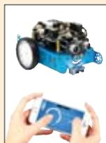
**Caractéristiques techniques :** Micro-contrôleur : Basé sur Arduino - Entrées : Lumière, infrarouges, ultrasons, présence, bouton - Sorties : Moteurs, Buzzer, LED RVB, infrarouge, ports - Communication : 2.4GHz ou port Bluetooth (selon version) - Modes de programmation : Scratch, Ardublock, Arduino - Alimentation : Batterie 3,7V lithium ou 4 piles AA / LR6 (non fournies) - Dimensions : 17x13x9cm
