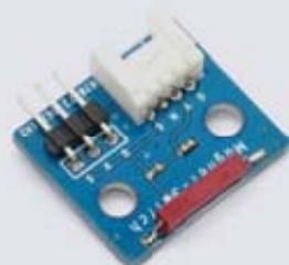
**Caractéristiques techniques :** Interface : GROVE 4 et 3 broches - Sortie : 1 contact travail - Alimentation 5V - consommation : inf. à 500µA - Dimensions : 24x21mm
