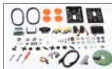
**Caractéristiques :** Châssis : Aluminium 2mm anodisé - Nombre de moteurs : 2 moto-réducteurs DG01D - Motoréducteurs : Engrenages métalliques 48:1 - Nombre de servomoteurs : 2 Servos S3003 - Nombre de capteurs : 1 capteur à ultrasons HC-SR04 - Interface de programmation : USB - Alimentation : 5 piles AA / LR6 (non fournies) - Dimensions : 157x149x160mm - Poids : 775g
