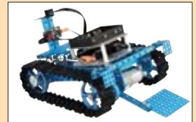
**Caractéristiques techniques :** Micro-contrôleur : Basé sur Arduino - Modules : Ultrasons, driver de moteurs, bluetooth, suiveur de ligne, capteur sonore - Communication : Bluetooth - Modes de programmation : Smart Control App (sans codage), Scratch, Arduino - Alimentation : 6 piles AA / LR6 (non fournies)
