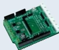
**Fonctionnalités :** Gestion des moteurs par la puce DRV8801 - Interfaces de communications - Interfaces pour capteur IR et US - Interface 9 axes - Sorties de puissance sur borniers - Alimentation séparée des moteurs
