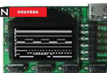
**Oscilloscope :** 2 vois @ 1Mohm - Niveau : -14 à +20Vdc - Bande passante : 200kHz - Echantillonnage : 2 M/s - Résolution : 8 bits - Profondeur : 256
