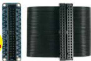
**Contenu :** 1 circuit Cobbler - 1 nappe 40 conducteurs - 2 connecteurs 2x20 pts à sertir - 1 connecteur Mâle 2x20 pts à souder - 1 barrette HE14
