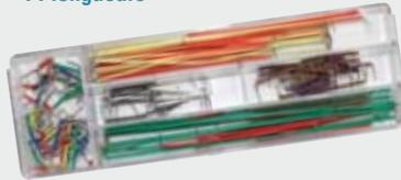
**Caractéristiques techniques :** Type : Fils nus dénudés - Genre : Rigide - Extrémités pré dénudées et coudées 7mm - Section : AWG22 / 0.22mm<sup>2</sup> - Diamètre du conducteur : 0.6mm - Longueur : 14 longueurs assorties - Couleurs : Assorties - Fourni en boîte compartimentée
