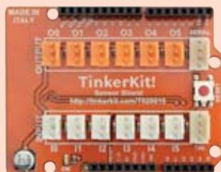
**Caractéristiques :** 6 sorties analogiques - 6 entrées analogiques - 1 sérieelle - 1 I<sup>2</sup>C - 1 bouton de reset - 1 LED d'alimentation - Dimensions : 68x54x26mm
