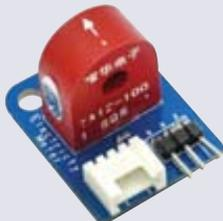
**Caractéristiques techniques :** Interface : GROVE4 et 3 broches - Courant mesuré : 0 à 5A - Fréquence du courant : 20 à 20000Hz - Courant de sortie : 0 à 5mA - Sortie : 200 ohm / 0 à 1V - Alimentation : 5V - Dimensions : 30x24mm
