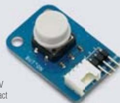
**Caractéristiques techniques :** Alimentation : 5V - Interface : GROVE 4 et 3 broches - Sortie : 1 contact travail - Dimensions : 36x14mm - Poids : 20g
