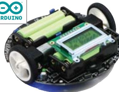
**Caractéristiques techniques :** Processeur : ATmega168 - Moteurs : 2 moto-réducteurs DC - Ratio : 30:1 (engrenages métalliques) - Contrôleur de moteurs : TB6612FNG 2 canaux - Afficheur : LCD 8x2 caractères - LEDs de signalisation : 2 - Connecteur de programmation : ISP - Tension d'alimentation : 3 à 7V - Alimentation : 4 piles AAA / LR03 (non fournies) - Dimensions : 9,5cm (diamètre) - Poids : 83g
