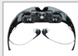
**Caractéristiques techniques :** Ecrans LCD micro-display - Résolution : 320x240 - Nombre de couleurs : 24-bit - Champ de vision : 26° - Format vidéo : NTSC / PAL / SECAM à sélection automatique - Ecran virtuel : 4,3, 50" à 2 mètres - Batterie : 3.7V / 1000mAh intégrée - Autonomie : 2 à 3 heures - Ecouteurs : 2 canaux stéréo
