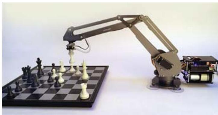
**Caractéristiques** : Compatible Arduino UNO - Programmation via Arduino IDE avec librairie dédiée - Contrôle par souris via application à télécharger compatible windows - Contrôle par application multi plateformes à télécharger - Contrôle via Android en option
