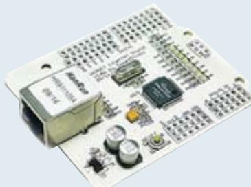
**Fonctionnalités :** Librairie : Arduino Ethernet Library - Visualisation de chaque paramètre par LEDs - Dédoublement des broches Arduino - Jusque 4 processus FTP ou UDP
