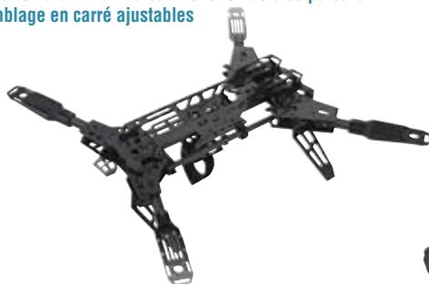
**Caractéristiques techniques :** Matériau du châssis : Fibre de carbone grade 3K - Matériau des supports moteurs : Aluminium - Architecture : En carré - Tubes porteurs : Ajustables - Entre-axes : 650mm moteur à moteur - Dimensions replié : 260x360x180mm - Poids : 646g
