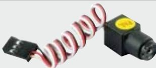
**Caractéristiques techniques :** Capteur : CMOS 1/3 - Taille du capteur : 4,75x3,55mm - Résolution : 786x576p - Sensibilité : 0,008Lux à F1.2 - Ratio S/B : 48dB - Angle de vue : 90° - Alimentation : 4 à 24V - Tension de fonctionnement : 12V - Consommation : 35mA - Température de fonctionnement : -10 à 50°C - Dimensions : 11x12x21mm - Poids : 4g
