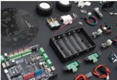
**Contrôleur :** Processeur : ATmega32u4 - Bootloader : Arduino Leonardo - Mémoire flash : 32Ko - SRAM : 2,5Ko - EEPROM : 1Ko - 10 entrées/Sorties numériques - 6 entrées analogiques - 4 sorties PWM - Tension d'alimentation : 6-9V -
