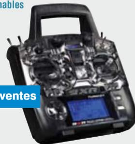
**Fonctionnalités :** 8 Canaux PPM ou 9 canaux PCM - Gère toute nacelle de caméra motorisée - Réglage des sticks en longueur - Trim digitaux sur tous les axes primaires - 16 modèles en mémoire - Commutateurs assignables - Mixage de canaux - Sub trim et travel ajustables - Réglage des flaps et différentiels - Mémorisation de position - Supporte les modes élico, Aéro et glider - Grille de programmation sur un modèle type - Supporte les mode 1 à 4 pour les stick - Mode 2 (Throttle à gauche)
