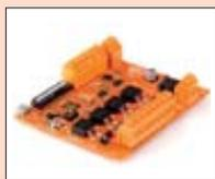
**Caractéristiques** : Slave DMX : jusque 128 modules en parallèle - Fonctionnement : Sortie - Capacité : jusque 24Vdc, par sortie
