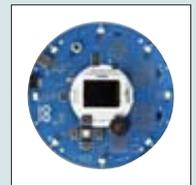
**Contenu :** 2 platines électroniques - 1 contrôleur Arduino ATmega 32u4 - 1 écran graphique 160x128 pixels - 1 compas électronique - 5 boutons de navigation - 1 potentiomètre - 1 haut parleur - 5 capteurs infrarouges - 6 zones de prototypage pastillées - 2 moteurs DC - Circuit de contrôle pour les moteurs - 2 roues - 2 Ballcaster - LEDs de visualisation
