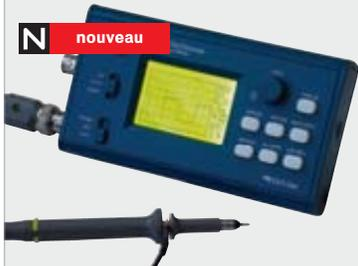
**Caractéristiques :** 1 voie - Sensibilité : 10mV à 5V/div. / 50Vpp max. - Impédance d'entrée : 1Mohm - Résolution : 8 bits - Couplage : AC, DC, GND - Echantillonnage : 2M/s temps réel (20M/s) - Base de temps : 0.5µs à 10mµs/div. - Longueur d'enregistrement
