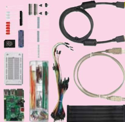
**Contenu :** 1 Raspberry Pi B+ - 1 Carte SD pré-chargeée - 1 Adaptateur plaque d'essais pour RPi - 1 plaque d'essais sans soudures - 1 câble USB - 1 câble HDMI - 1 lot de câbles souples de liaison - 1 boîte de 140 fils rigides - 5 LEDs rouges 5mm - 1 LED rouge cristal 5mm - 1 LED verte cristal 5mm - 1 LED bleue cristal 5mm - 2 boutons poussoir - 1 potentiomètre 10k - 1 potentiomètre 1k - 1 photorésistance - 10 résistances 100ohm - 10 résistances 1k - 10 résistances 10k
