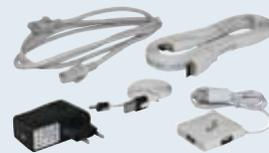
**Contenu :** 1 alimentation USB 5Vdc / 2A - 1 Hub USB 4 ports - 2 cordons USB / micro-USB - 1 cordon HDMI de 1,5 m - 1 câble réseau de 2m
