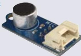
**Caractéristiques techniques :** Interface : GROVE4 et 3 broches - Bande passante : 100 à 10000Hz - Sensibilité : -50dB - Alimentation : 5V - Consommation : 260µA - Dimensions : 33x14mm
