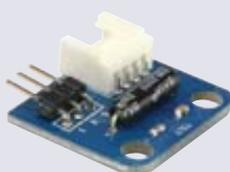
**Caractéristiques techniques :** Interface : GROVE4 et 3 broches - Détection : Inclinaison de plus de 15° - Sortie : Contact sec - Alimentation typique 5V / 450µA - Dimensions : 24x21x2mm - Poids : 15g
