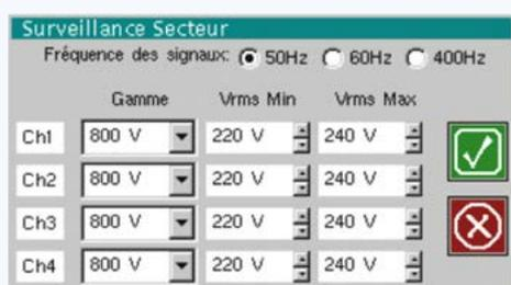
Surveillance jusqu'à 4 voies simultanées
