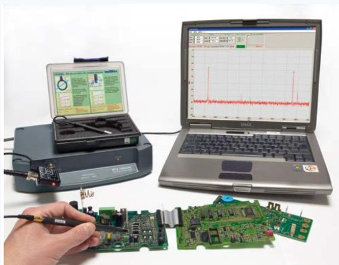
Utilisation de la sonde de contact, ainsi que de l'amplificateur connecté directement au MTX 1050
