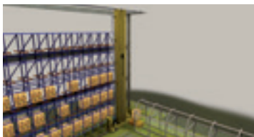
Magasin automatisé : Déplace, stocke et retrouve les caisses dans un espace de stockage
