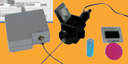
▲ Le porte cuve connecté au spectromètre permet l'étude des filtres colorés et la réalisation de toutes vos manipulations de spectrophotométrie.
