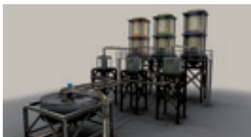
Système de mélange : Mélange les trois couleurs primaires (rouge, vert et bleu) pour obtenir la couleur souhaitée
