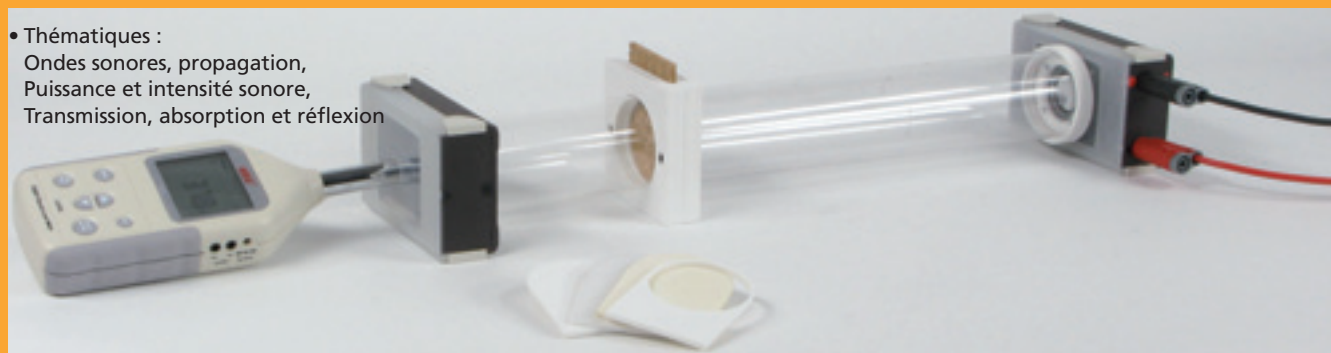
▲ Mesure d'un niveau sonore. Étude des isolants en absorption, transmission et réflexion.
