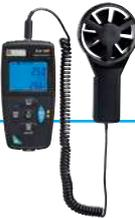
Mesure de température, vitesse et débit d'air
