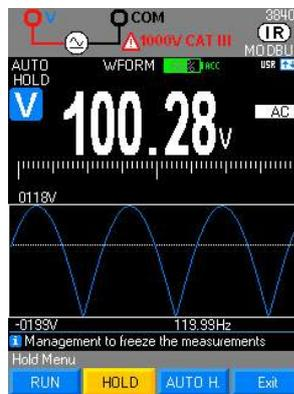
Mode Waveform : visualisation d'une forme d'onde en auto BP 600 Hz
