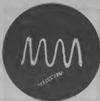
Courant correct, léger déphasage.
