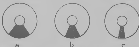
Fig. 32. — Réglage MF sur l'œil magique. On part de a pour aboutir à c.
