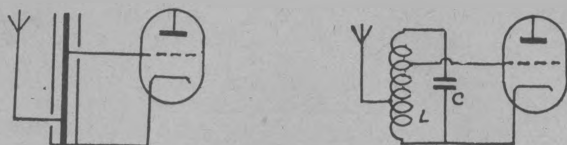
Fig. 35. — Le tronçon de ligne coaxiale de gauche équivaut au circuit oscillant de droite.
