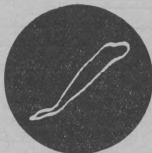
IX. — ACCIDENTS DÉCÉLÉS PAR COMPARAISON DE DEUX COURANTS Léger déphasage. Harmonique 5. Déphasage et saturation. Fort déphasage. Harmonique 5.
