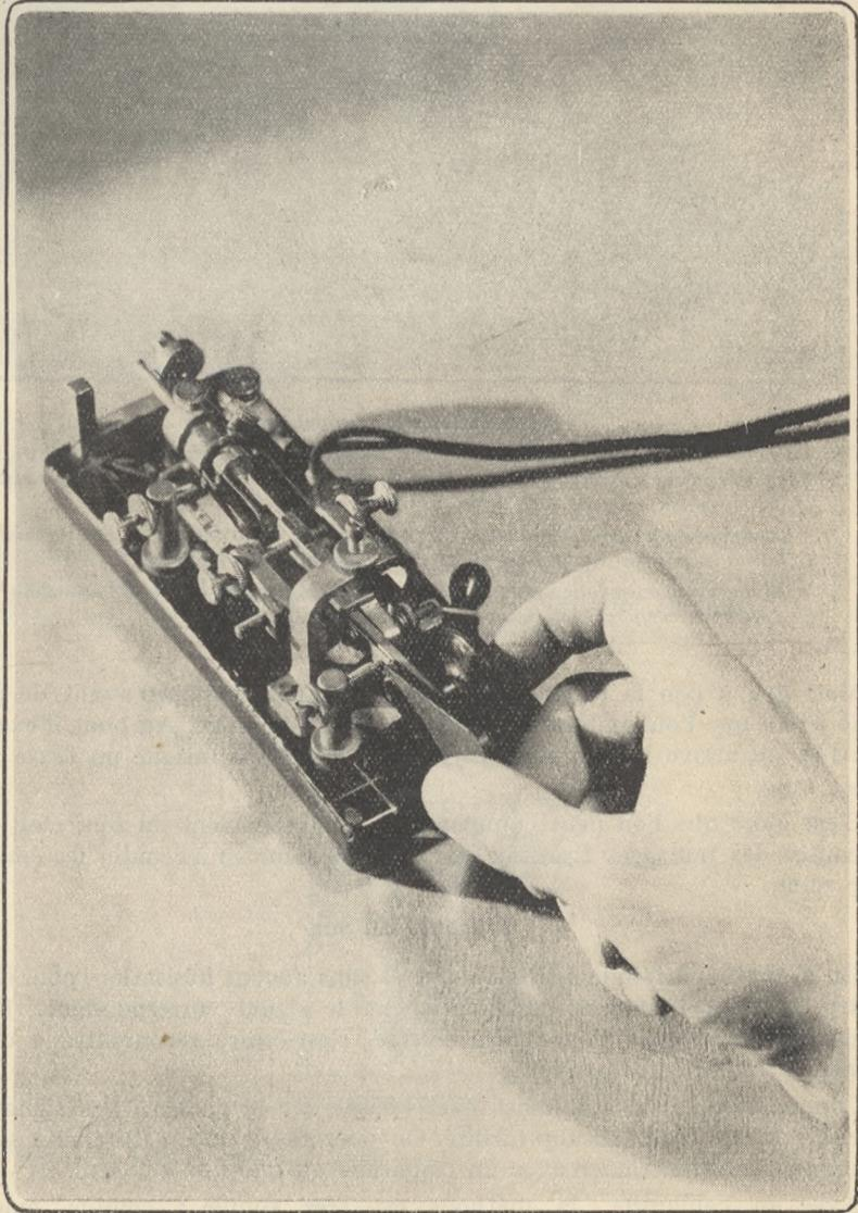
Manipulateur automatique à double action (Bug « Vibroplex »)
