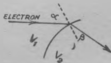
Fig. 10 b. — Réfraction d'un rayon cathodique.
