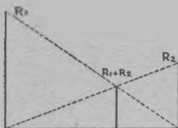
Fig. 3. — Deux résistances en parallèle.
