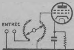
Fig. 10. — Branchement du potentiomètre à impédance constante.
