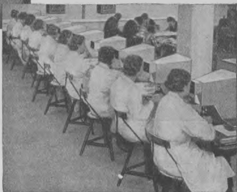
Vérification du boudi- nage des filaments.
