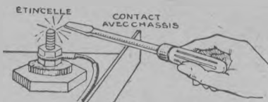
Fig. 3. — Essai d'un condensateur de filtrage avec le tournevis.
