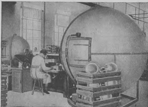
Un photomètre à sphères d'intégration pour la mesure des flux lumineux.
