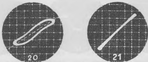
Fig. 12. — VERIFICATION DU DEPHASAGE D'UN PUSH-PULL 20 : Inégalité de tensions, écart de phase 20^\circ . 21 : Bon déphasage.
