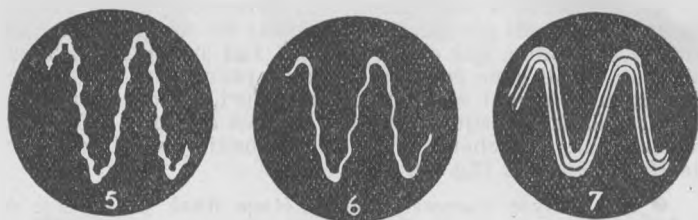
Fig. 8. — TRACES DE SECTEUR DANS LA H.T. (5) ET DANS LES CIRCUITS DE GRILLES B.F. (6 et 7).
