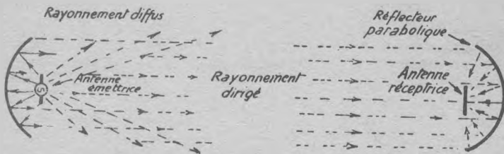
Fig. 4. Principe des communications en hyperfréquence par ondes dirigées à l'aide de réflecteurs.
