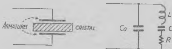
Fig. 156. — Equivalence d'un cristal piézo-électrique avec un circuit oscillant. C_0 : Capacité au repos. L , C , R : constantes électriques dépendant des dimensions et du type de taille du cristal. Elles traduisent respectivement la masse, l'élasticité et les pertes par frottement du cristal vibrant.
