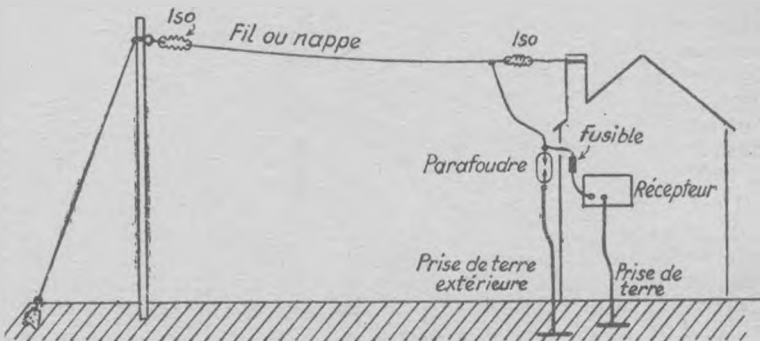
Fig. 231. — Antenne extérieure courante.
