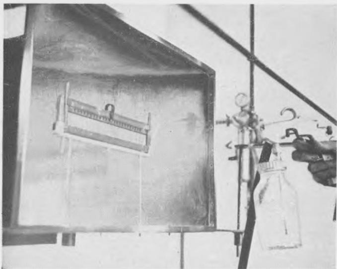
Vue partielle d'un poste de recouvrement des cathodes des lampes de réception. Une couche d'oxydes émetteurs d'électrons est déposée sur les cathodes. L'opération est contrôlée automatiquement, car la variation admissible de poids de la couche est de l'ordre du milligramme.
