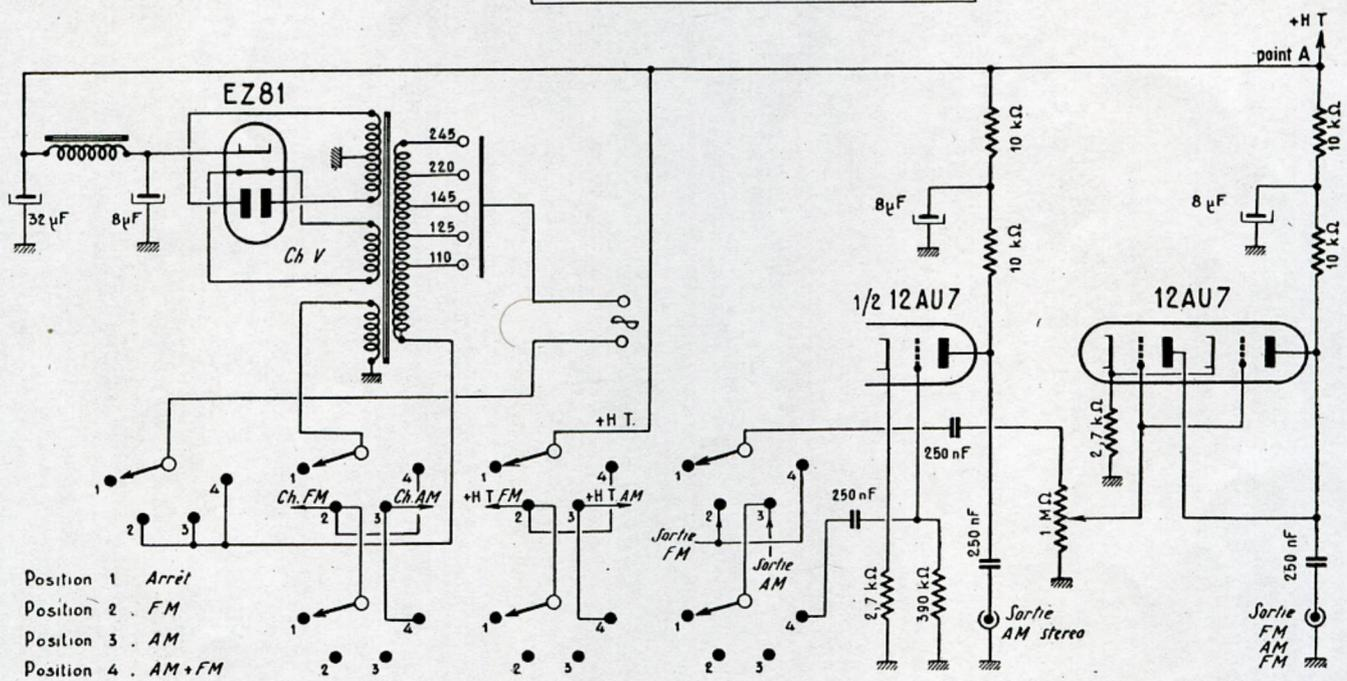
Le Tuner AM/FM stéréo E.S.A.R.T. est en fait constitué des sections H.F. de deux récepteurs : FM (schéma de gauche) et AM (ci-dessus) avec alimentation commune et sélecteur de fonctions permettant l'emploi individuel ou simultané. Une variante AM perfectionnée (détection Sylvania) sera également offerte.
