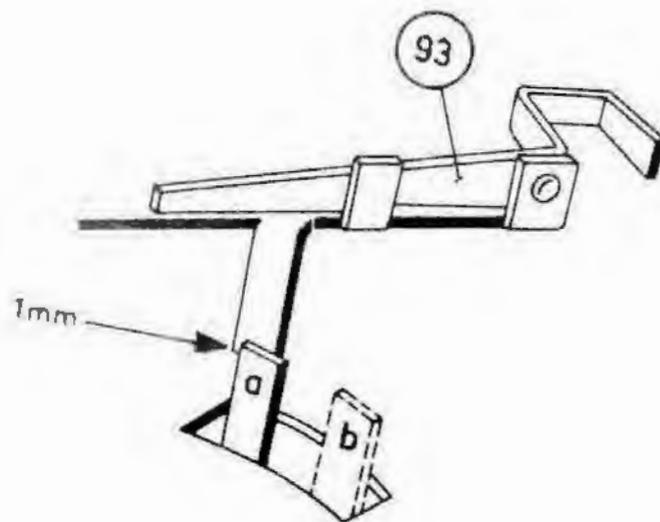
4. La tension mécanique préalable du ressort de traction fixé à l'étrier 19 de la roue dentée doit être de 10 à 25 g. mesurée sur la butée (voir la fig. 9).
