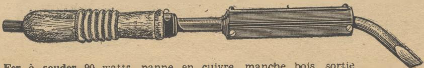
Fer à souder 90 watts, panne en cuivre, manche bois, sortie de fil alimentation isolée par caoutchouc robuste, convient pour atelier. Spécifier le voltage 110 ou 220 N° 308 résistance de rechange N° 309
