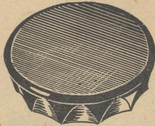
Bouton conique bakélite marron, face connexe, côté à facettes, diamètre 35<sup>m</sup>/m; hauteur 15<sup>m</sup>/m (2.203) avec bague cuivre fendue pour axe de 6<sup>m</sup>/m, vis pointeau acier.
