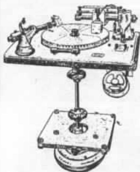
Fig. 6 : Machine à graver modèle R 25 PV « pour l'enregistrement direct professionnel » (1946).
