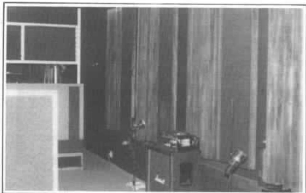
*Fig. 5 : Une partie du dispositif de contrôle acoustique dans la configuration d'absorption maximum. Au premier plan, un panneau amovible et au fond la cabine batterie ouverte.*
