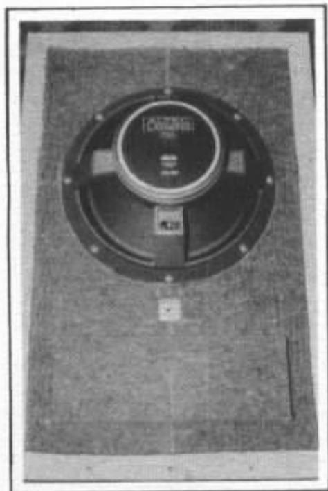
*Photo 30 : Collage du feutre sur la face avant. Bien laisser l'espace suffisant aux tasseaux.*
