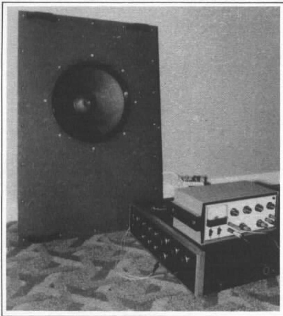
Photo 32 : Matériel pour le vieillissement des haut-parleurs. Noter sur la face avant la présence des petites poignées qui, ici, sont très visibles mais se sont fondues dans l'ensemble après les finitions.
