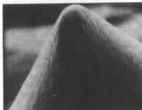
Fig. 2 : Degré de polissage d'une pointe lectrice en diamant (profil hyper-elliptique). En haut, un polissage conventionnel de qualité. En bas, polissage exceptionnel obtenu par le procédé Masar Polish.
