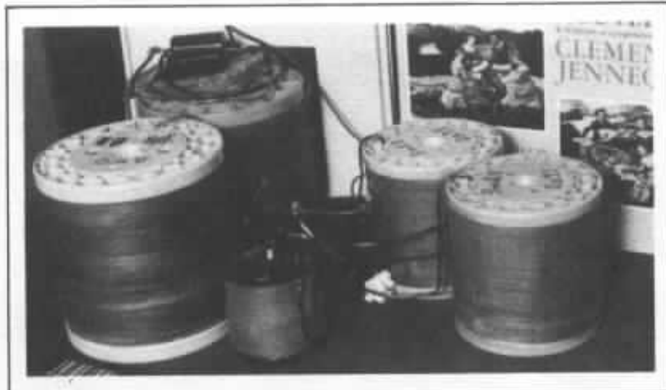
Fig. 6 : Prototype de filtre employé pour les essais. On notera le volume très imposant des selfs.
