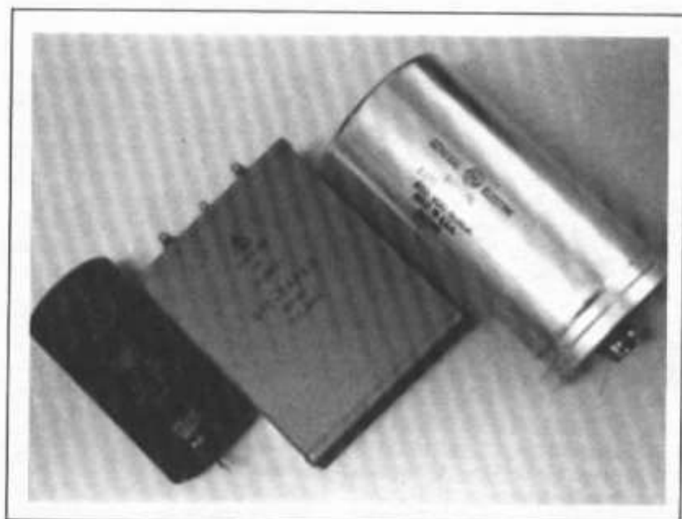
Fig. 28 : Condensateurs utilisés pour l'alimentation. A gauche un modèle de valeur 500 \mu\text{F} 450 V. Au centre un condensateur au papier huilé (marque SIC-SAFECO) de valeur 10 \mu\text{F} 600 V. A droite un condensateur de valeur 2,200 \mu\text{F} 450 V (marque General Electric). Ces condensateurs peuvent être utilisés sur le premier étage, alimenté par 400 V.
