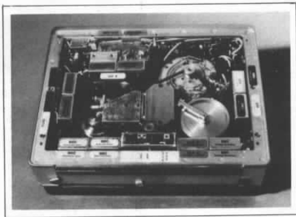
Fig. 10 : Vue interne du Stellavox SP8. On distingue les modules enfichables (on remarquera, sur la droite, que deux modules ont été volontairement inversés pour montrer l'intérêt du système fort simple des étiquettes permettant, d'un seul coup d'œil, de vérifier si tout est en ordre.
