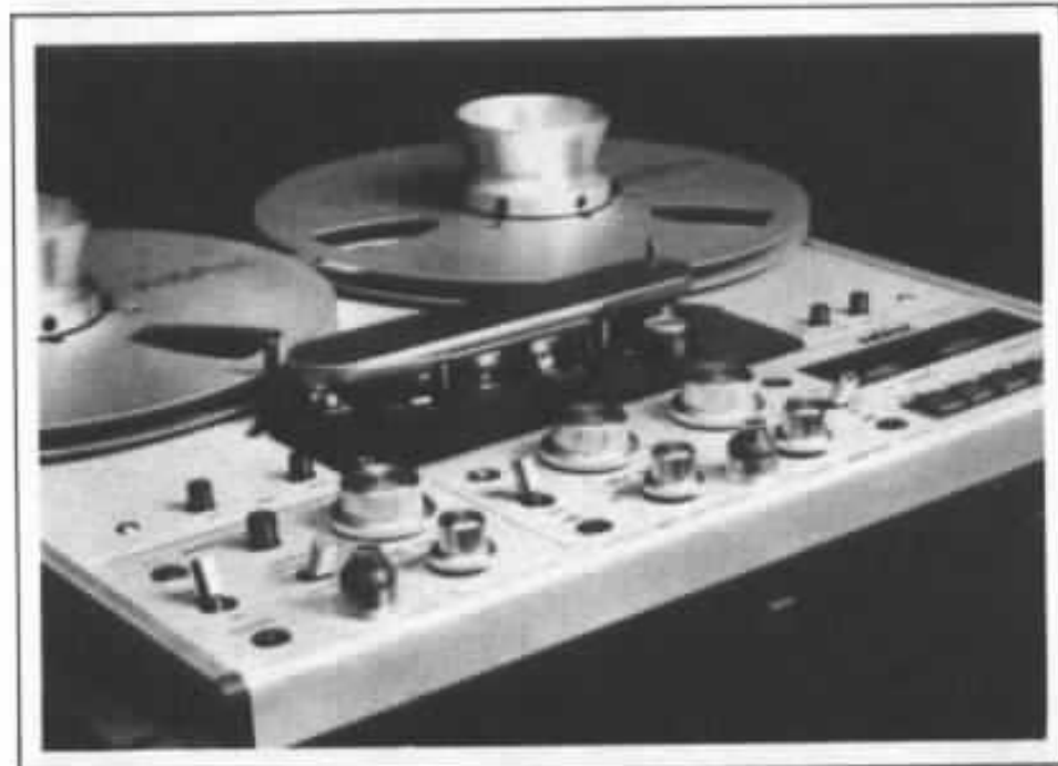
Fig. 14 : Magnétophone Revox PR 99. Le bloc des têtes est maintenant bien dégagé par rapport à la platine et aux commandes.
