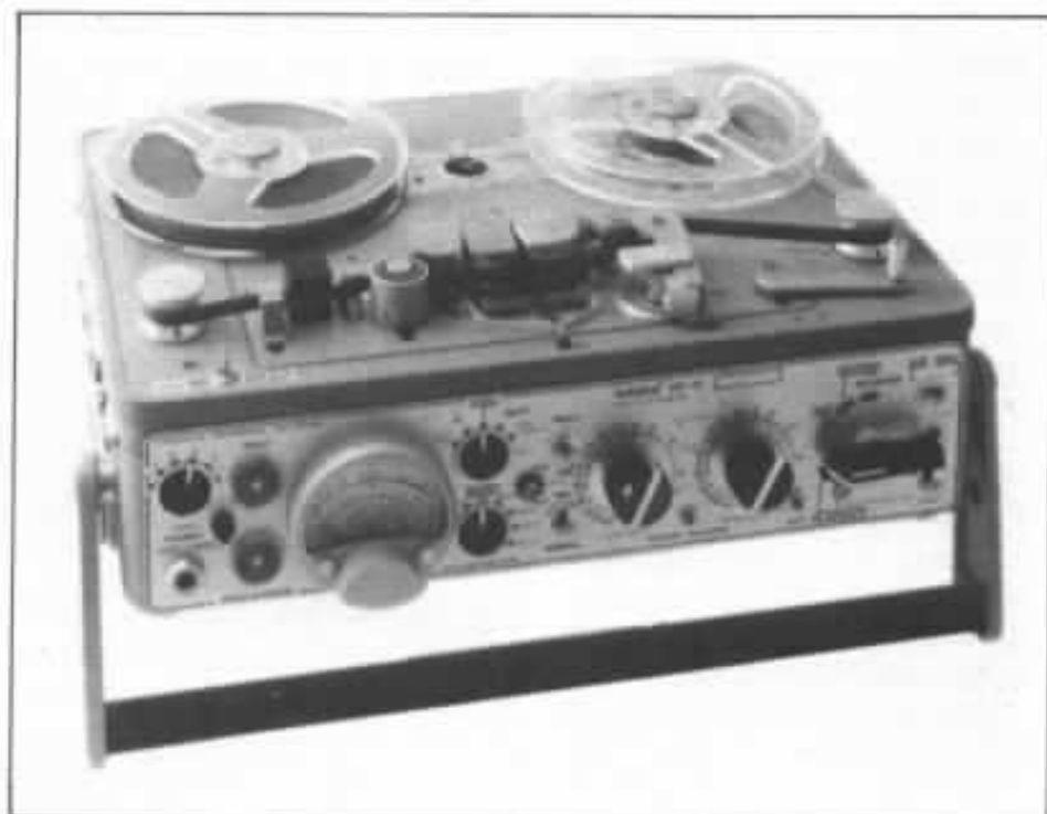
Fig. 4 : Magnétophone autonome Nagra IV-S avec tête pilote. Cette dernière version est maintenant équipée de volets à bascule protégeant les têtes magnétiques contre un rayonnement parasite.
