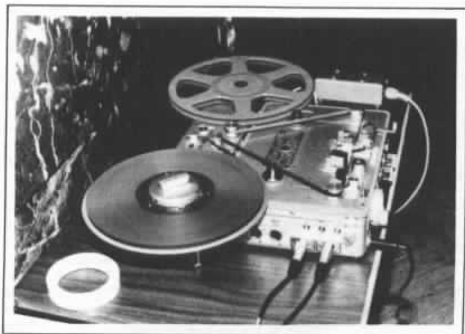
Fig. 7 : Nagra IV-S avec son adaptateur pour grandes bobines (QGB) et l'adaptateur secteur ATN 2.
