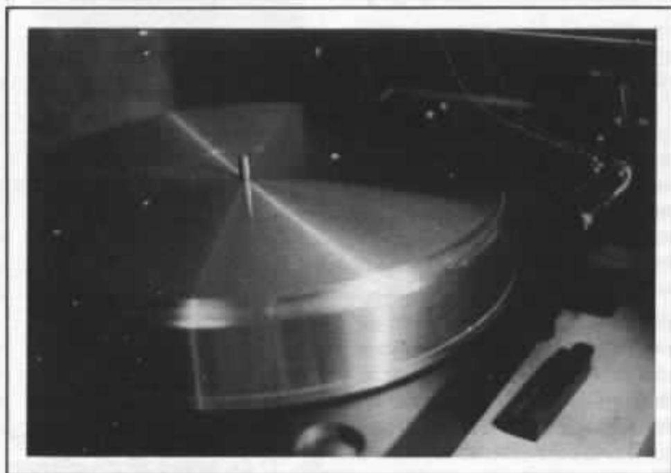
Fig. 3 : La platine Micro et le bras Goldmund. On remarquera le sac rempli de grenaille de plomb posé sur le châssis du bras et le fil de Litz partant en direction du préamplificateur.
