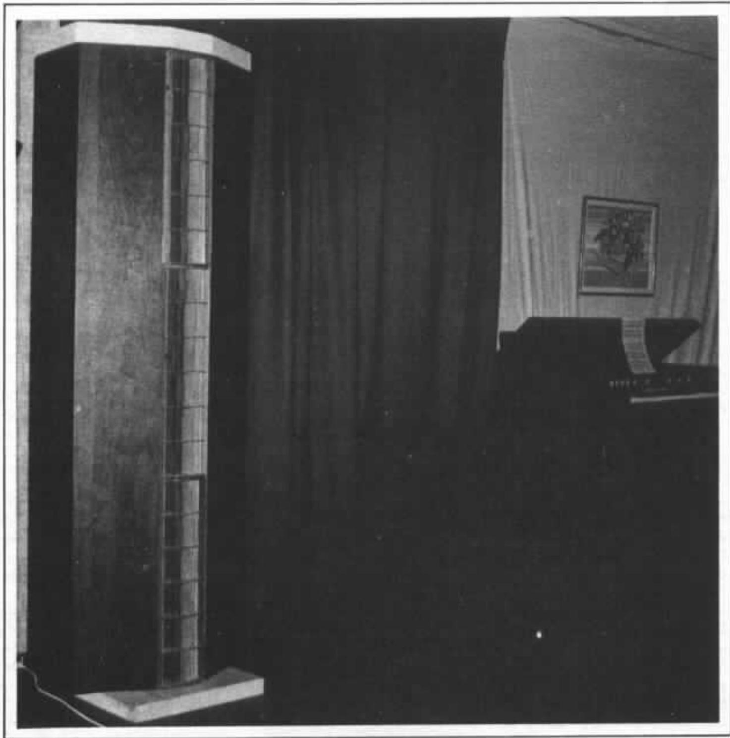
*Fig. 7 : Une des enceintes Beveridge dans la pièce d'écoute, prise entre deux dalles de marbre.*
