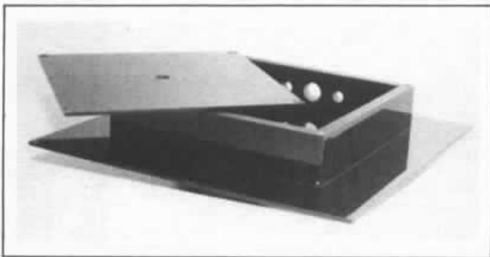
Fig. 5 : Boîtier de plexiglass recevant le filtre médium-aigu fixé sous le satellite.
