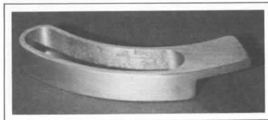
Fig. 14 : Auget fraisé dans un bloc de dural avant son montage sur le bras.
