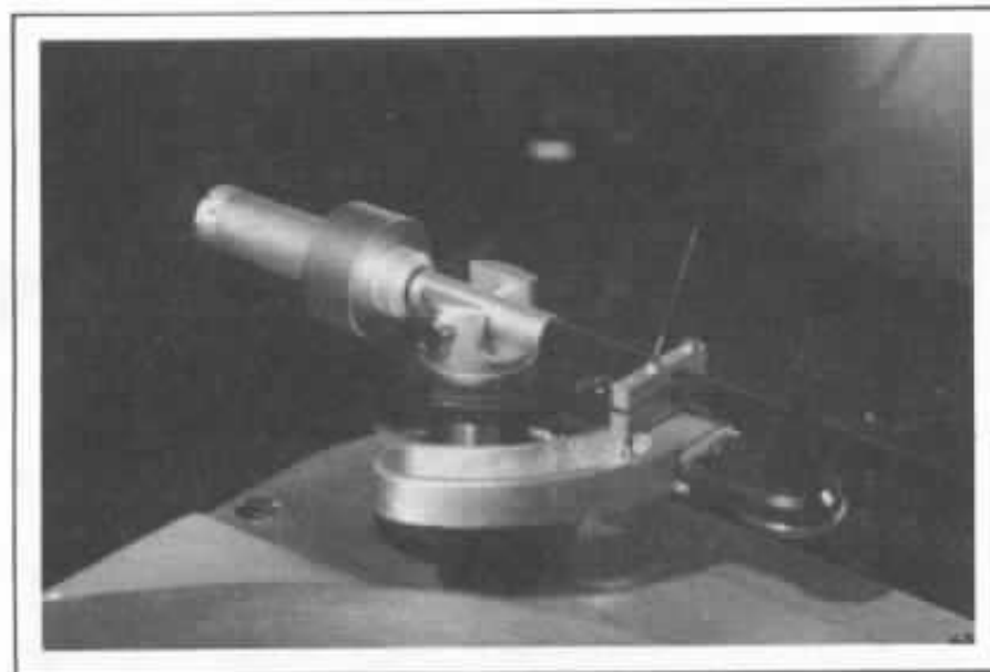
Fig. 13 : Dispositif d'amortissement ajouté au bras ADC.
