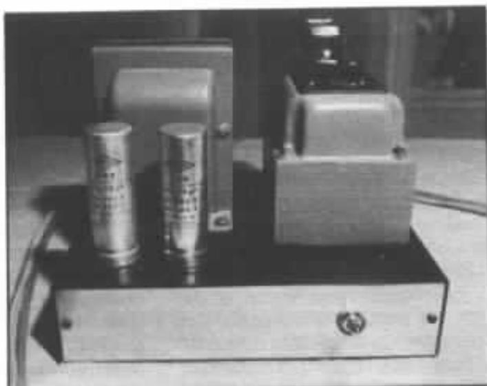
*Le bloc alimentation. Il est commun aux deux blocs mono amplificateur.*
