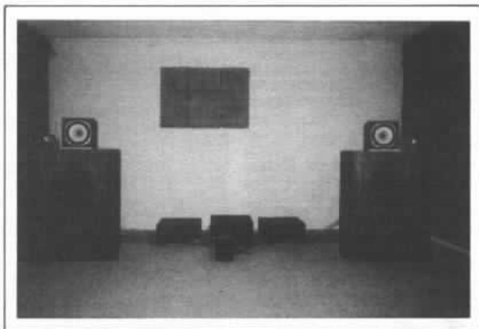
*Système d'écoute ayant guidé la mise au point. Il est constitué d'un filtre actif FA1 circuit Kanéda, de trois amplificateurs 20 W Hiraga, les enceintes utilisent la Petite Onken équipée du 414-8 E dans le grave, le Lowther PM 6 et le Fostex T 925 complètent la restitution dans le médium-aigu.*
