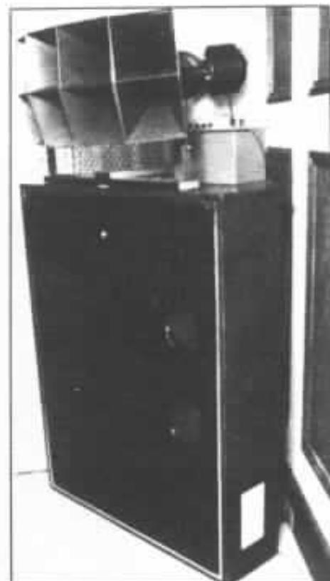
Enceinte JBL D 31050 avec voie grave équipée de deux Altec 515 C avec pavillon. Le médium est confié à 2 moteurs Altec 288 C associés au pavillon 10 cellules 1005 B. Dans l'aigu, le tweeter Gauss 1502 prend le relais. (Photo Stereo Sound).
