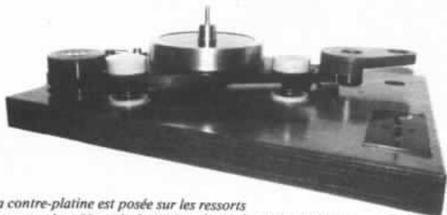
*La contre-platine est posée sur les ressorts de suspension. Noter la facilité évidente de cet assemblage.*
