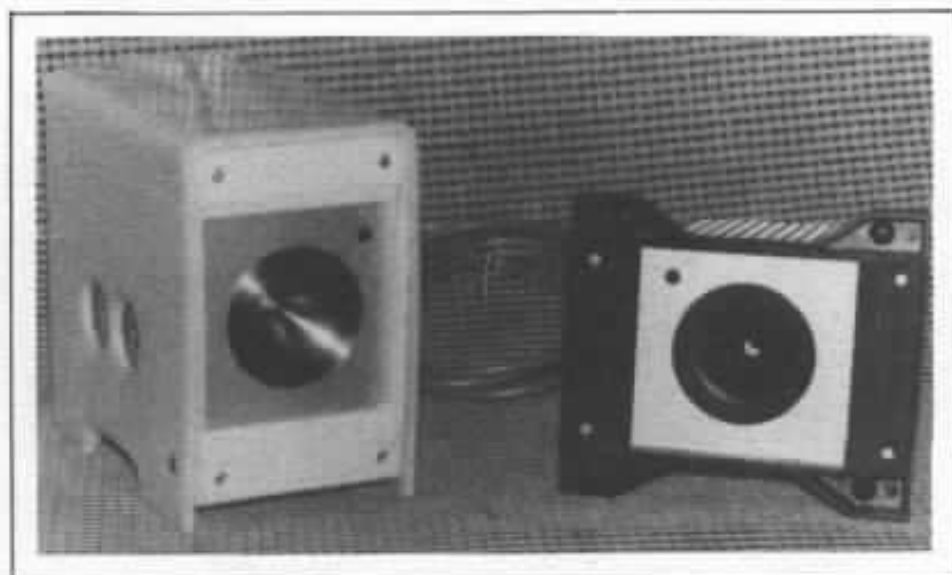
Les deux versions du tweeter ionique, celle de droite peut être intégrée à l'ensemble de cellules.
