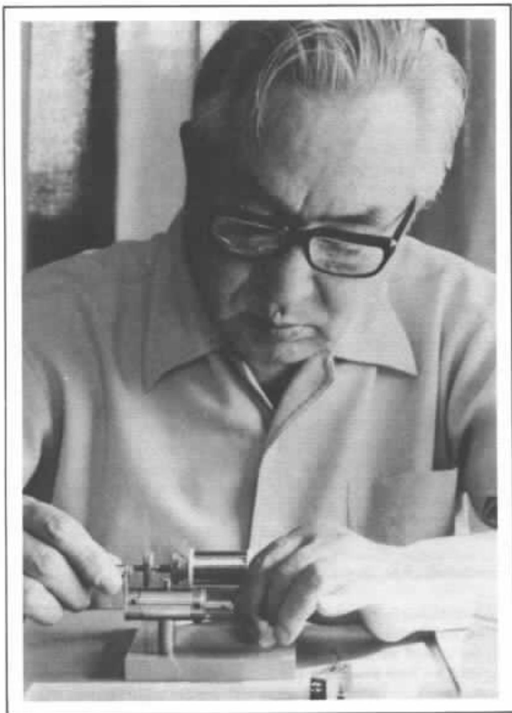
*Bobinage à la main des quatre bobines*
