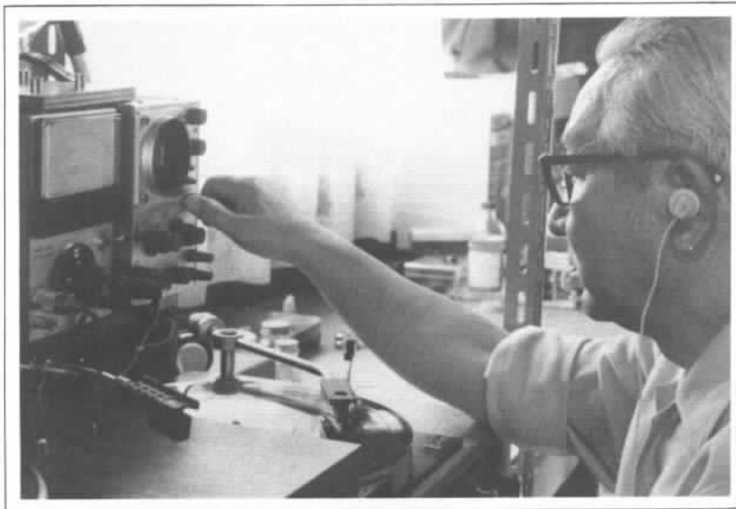
*Mesure de la distorsion, de la diaphonie, et du niveau de sortie de chaque cellule fabriquée.*
