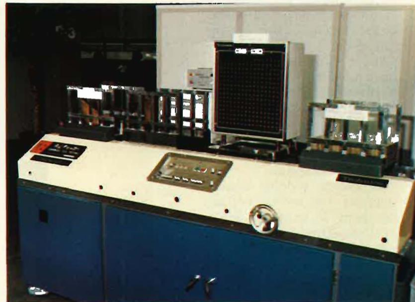
Machine de contrôle automatique de 256 points de liaison
