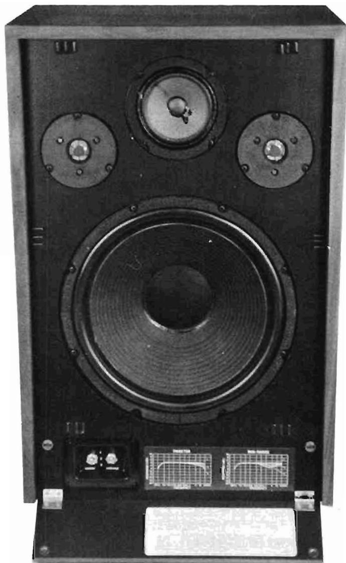
d'écoute ces réglages permettent de trouver un équilibre sonore convenable. Deux graphiques expliquent clairement l'influence de ceux-ci sur la courbe de réponse. Il nous semble intéressant de signaler qu'en l'absence de sonomètres et disques de fréquences que l'on peut approcher d'un réglage convenable en désaccordant son tuner entre deux stations et en retirant le muting, ce qui procure aux enceintes un bruit blanc (cf dans ce mêm-
