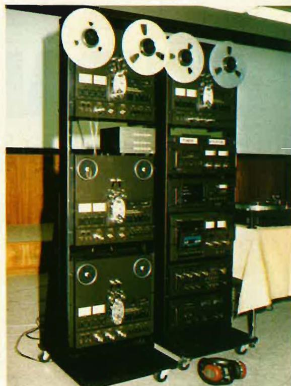
Une étonnante performance de stabilité de vitesse, les trois magnétophones superposés RS 1500US tournent ensemble sur une même bande magnétique.
