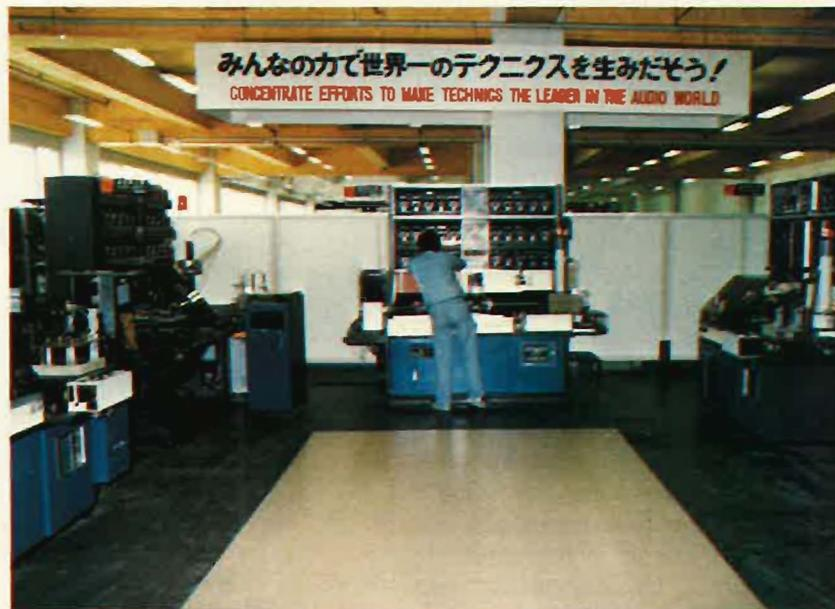
Insertion automatique des composants par les machines Technisert
