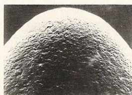
Ook hier een te grote diamant. Bovendien is de tip verkeerd geslepen. De linker illustratie toont duidelijk de grote dot lijm, waardoor de tipmassa (bewegende massa) van de naald onnodig toeneemt. Opnieuw een scheef gemonteerde naald, waardoor ook hier de spooreigenschappen ver beneden de maat blijven.
