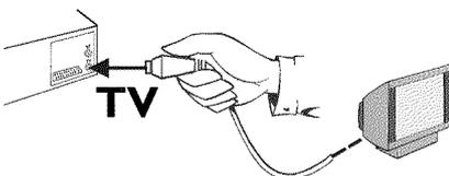
Raccordez, à l'aide du câble d'antenne fourni, la fiche TV située au dos du magnétoscope avec la fiche d'entrée de l'antenne du téléviseur.
