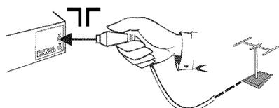
Retirez la prise du câble d'antenne de la fiche du téléviseur. Raccordez-la à la fiche Γ située au dos du magnétoscope.
