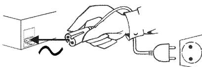
Raccordez, à l'aide du câble de réseau fourni, la fiche ~ située au dos du magnétoscope à la prise murale.
