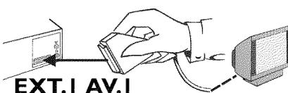
Raccordez, à l'aide du câble péritel fourni, la fiche EXT.1 AV. 1 située au dos du magnétoscope avec la fiche du téléviseur prévue pour la lecture du magnétoscope (veuillez consulter le mode d'emploi de votre téléviseur).
