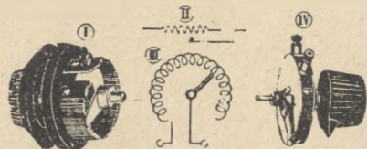
Rhéostat : I. Rhéostat de chauffage pour lampe. — II. Symbole schématisé d'un rhéostat. — III. Schéma de montage d'un rhéostat. — IV. Rhéostat de grille.
