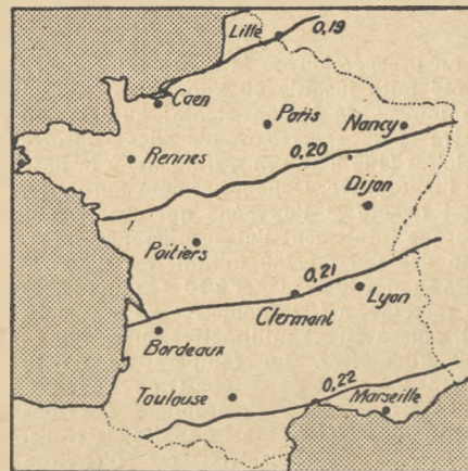
Carte de France indiquant la répartition des lignes isodynamiques à la surface du sol. Les chiffres placés près des lignes indiquent la valeur du champ magnétique terrestre en gauss (unités électromagnétiques absolues).
