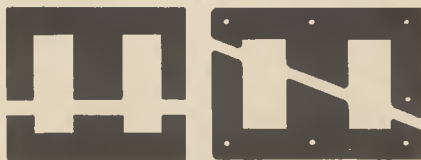
Profils de tôles découpées pour circuit magnétique de transformateurs à basse fréquence.
