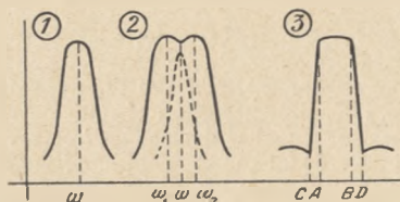
Forme comparée de diverses courbes de résonance : 1. Circuit résonnant simple; 2. Transformateur de bande; 3. Filtre de bande : AB, bande passante; CA, BD, frontière des zones d'élimination.
