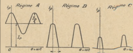
Divers régimes de fonctionnement des lampes électroniques : Régimes A, B et C.
