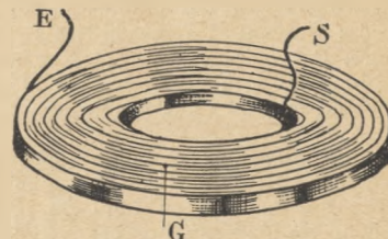
Bobine en galette: G, bobinage spiral aplati en forme de galette; E, S, entrée et sortie de l'enroulement.
