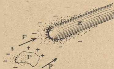
Électrisation d'un morceau de papier : E, bâton d'ébonite électrisé par frottement. — F, force attractive entre les charges négatives du bâton et les charges positives, induites par influence dans le morceau de papier P, tandis que les charges négatives sont repoussées.
