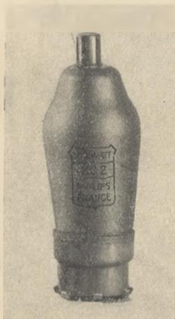
Dans le cas d'amplification à basse fréquence, les connexions seront établies pour qu'il existe le minimum de tension entre le filament et la masse du châssis (on branchera donc ce tube après la diode de détection).
