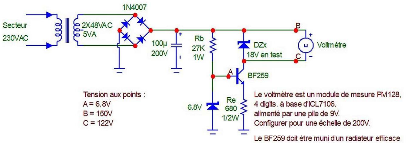
Permet de tester les diodes "Zener" jusqu'à 145V
