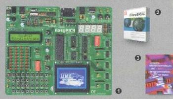
1) EasyPIC4: Starter-kit pour développement sur microcontrôleurs PIC<sup>TM</sup> - Programmeur USB intégré, supports pour PIC 8, 14, 20, 28 et 40 broches, livré avec PIC16F877, emplacements pour afficheurs LCD 2 x 16 et afficheur LCD graphique 128 x 64 (livrés en option), 32 leds, 32 boutons-poussoirs, 4 afficheurs 7 segments, emplacement pour capteur température DS18S20 (livré en option), connecteur pour clavier PS/2 (non livré), port série, etc. .... 129,50 €
