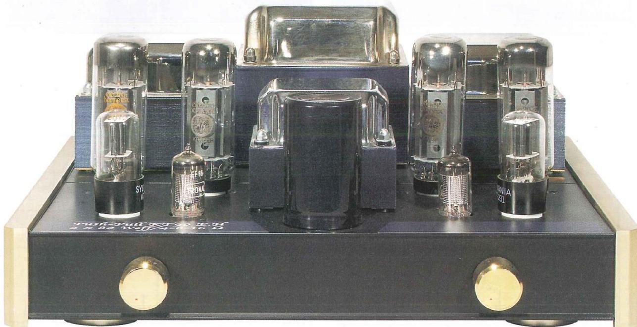
**L'étude proposée est basée sur la tétrode KT90 E.H utilisée en Push-Pull afin d'obtenir un élargissement du spectre audio aux basses fréquences qu'il serait impossible d'avoir avec un Single End.**
