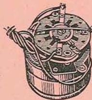
Le premier, dont la vitesse de l'axe de sortie est de 2 tours minute fonctionne directement sur 110 V ou, par l'intermédiaire d'une résistance série de 5 000 Ω 5 W, sur le secteur 220 V. Son axe de sortie entraîne un commutateur rotatif à 1 galette, 1 circuit et 4 positions diamétralement opposées. Il est donc possible de prévoir avec cet ensemble l'allumage et l'extinction de 4 lampes ou autres appareils électriques à intervalles régu-
