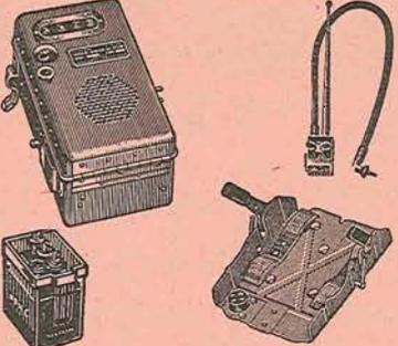
4 fréquences pré-réglées par boutons-poussoirs avec réglage instantané sur chaque fréquence et réglage accord antenne.
