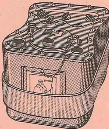
Le découplage de la porteuse peut être automatique ou manuel. Automatique, il est effectué par un système mécanique incorporé, passant pendant 20 secondes des S.O. suivis par 20 secondes d'un tra prolongé sur la position « *Auto 1* » et sur « *Auto 2* » AA suivi également d'un trait de 20 secondes. En « *Manuel* », la manipulation s'effectue en pressant un bouton étanche ce qui donne, soit une émission en ondes entretenues pures (1) soit un signal découpé modulé à la fréquence de 1 000 Hz.
