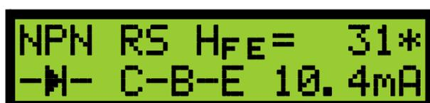
Cet écran montre la mesure imprécise du gain pour un transistor de type ESM113. Ce transistor possède une diode de protection et une résistance shunt
