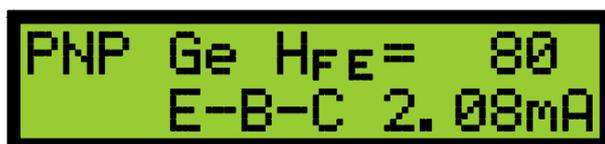
Cet exemple montre l'affichage lorsqu'un transistor au Germanium de type PNP est détecté par le PRODETERMINATOR
