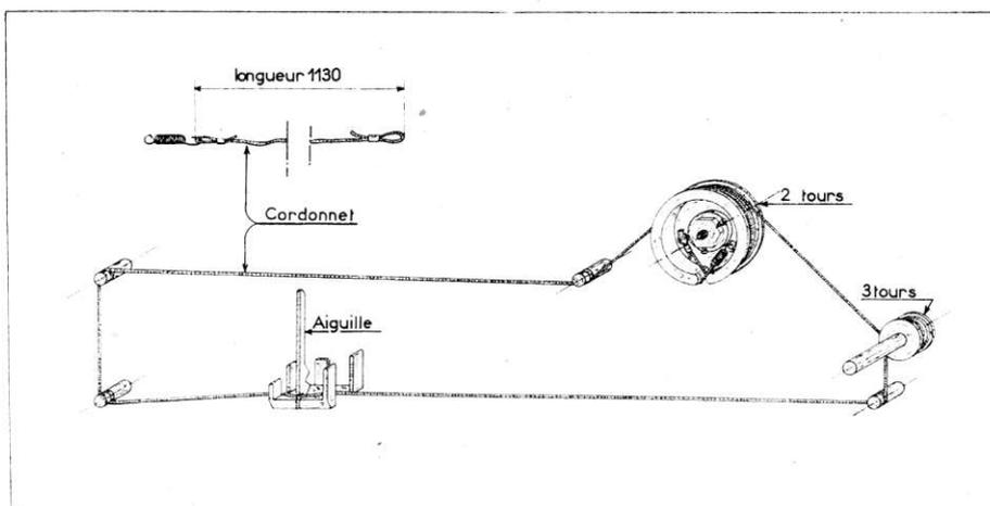
**NOTA.** — L'entraînement C. V. représenté ci-dessus est celui de la version table. Dans la version portable, les poulies sont déplacées, et le nombre de tours sur la poulie du C. V. est de 2 tours  $\frac{1}{2}$  position C. V. fermé.
