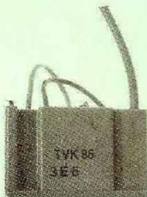
REMARQUE : Dans le cas des TVK 31 ou 52, le condensateur C 1418 doit être de 6,8 nF code commande 4811 121 37004. Dans le cas du TVK 86, C 1418 doit avoir une valeur de 7,5 nF code 4811 121 37008, et la diode D 1405 BY 176 est supprimée (cette dernière fait partie du tripleur TVK 86).
